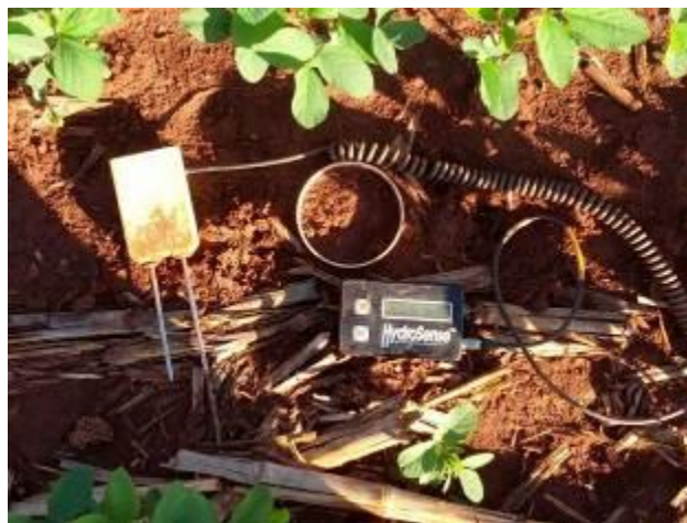
Figura 8: TDR - Hydrosense system, dispositivo portátil utilizado para a mensuração da umidade do solo.
