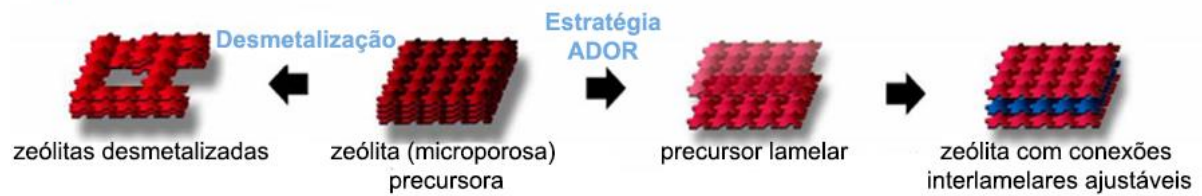
Figura 6 - Estratégias gerais para o design avançado da porosidade das zeólitas por métodos top-down .
