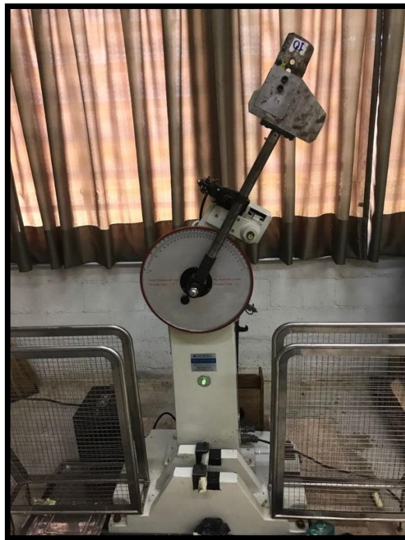
Figura 8. Dispositivo de ensaio de impactos adaptado para avaliação das lâminas.
