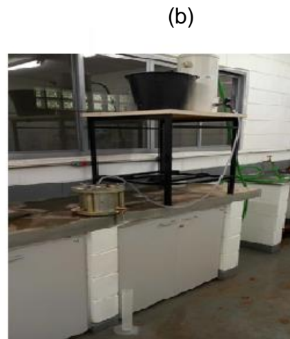
Figura 30- Ensaio de permeabilidade com carga constante: (a) Ensaio de forma esquemática; (b) Aparato montado em laboratório.
