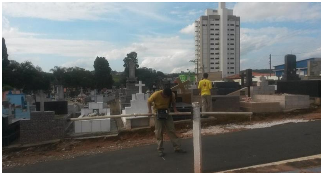
Figura 26 - Ensaio realizado com o condutivímetro de solo EM-31 no perfil EM 8 na necrópole Nossa Senhora Aparecida, Piedade, SP, executado pela equipe técnica da GPR Geoscience Geofísica Ltda.
