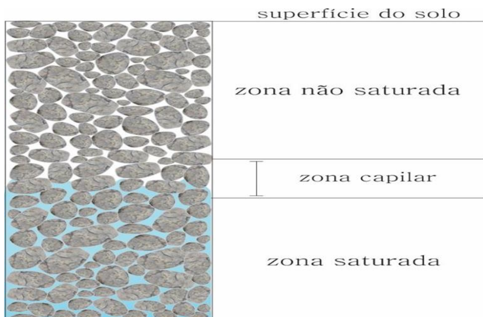
Figura 5 - Representação esquemática de subsuperfície, onde a partir da superfície em profundidade tem-se as zonas não saturada, capilar e saturada
