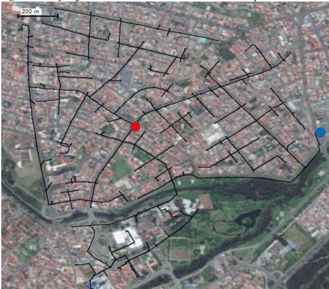
Figura 56 – Topologia do alimentador 0324 da cidade de Cuenca-Ecuador.
