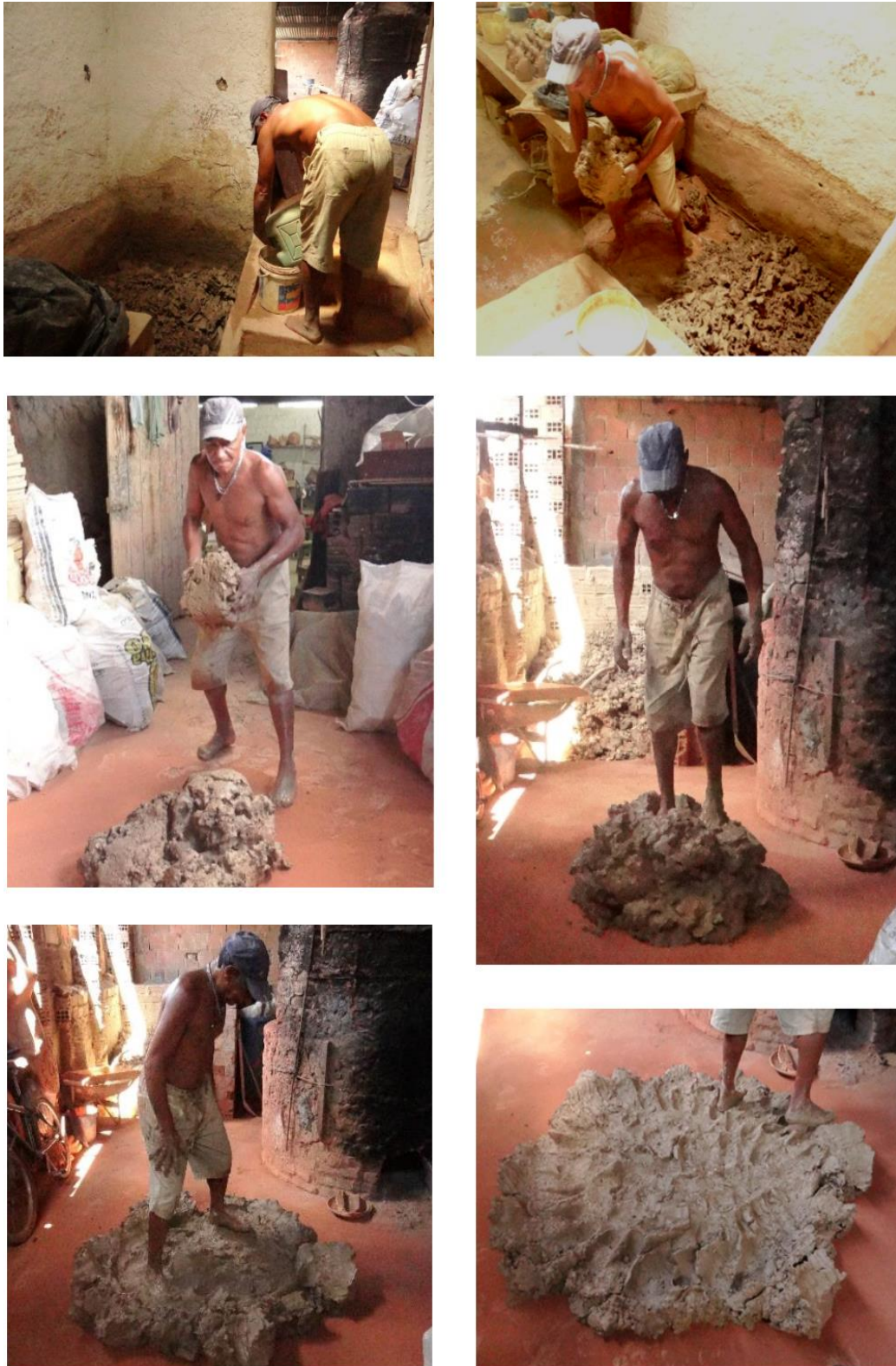
Fig. 25 Quadro com processo de preparo barro no ateliê de Fernando de Zezinho Tracunhaém/PE, 2016. Foto Vanessa Bezerra.
