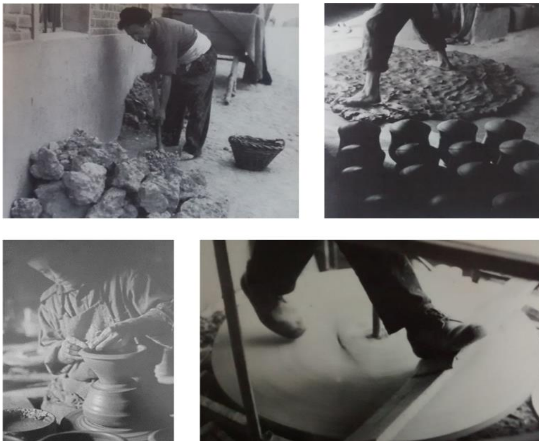
Fig. 23 Quadro com processos de coleta, preparo do barro e modelagem em torno de oleiro no interior da Espanha, década de 1970. Fonte: Llorens Artigas, 1970, p.75.
