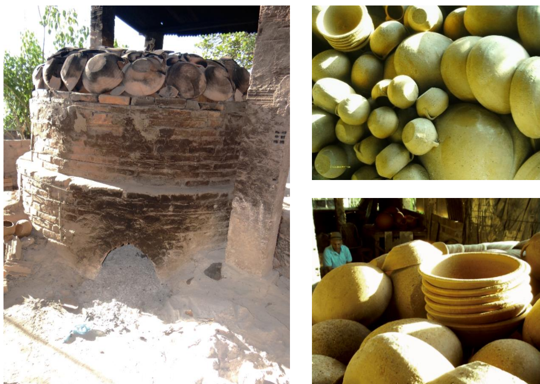
Fig. 150 Forno da olaria do Mestre Da Hora ainda coberto com os cacos, ao lado alguidares, tachos e panelas dentro do forno. Tracunhaém/PE, 2016. Foto: Vanessa Bezerra.
