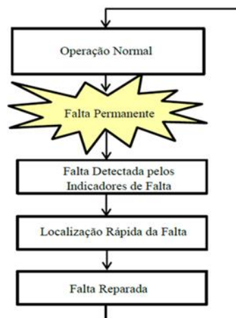
Figura 1 – Localização de uma falta por meio de um dispositivo IF.
