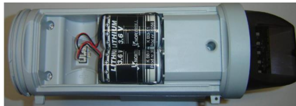
Figura 2 – Destaque para a bateria interna de um IF de poste.
