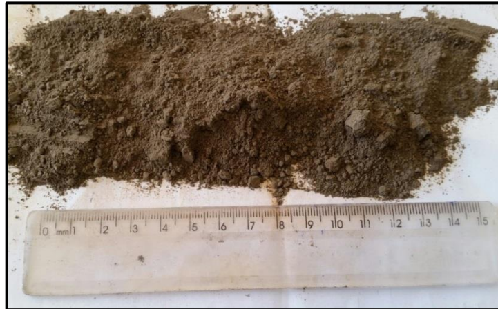
Figura 18 - Cinza de folha de cana-de-açúcar moída e peneirada
