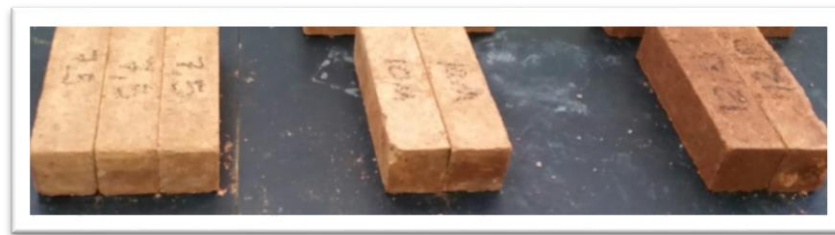
Figura 20 – Corpos-de-prova para o ensaio de compressão
