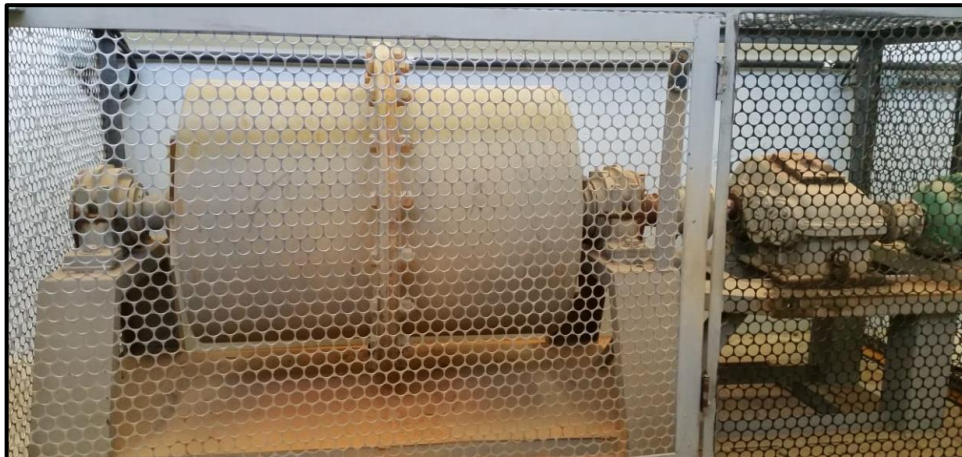
Figura 15 – Imagem do moinho de bolas utilizado para moagem
