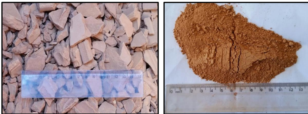
Figura 19 - Resíduo de cerâmica vermelha antes e após a moagem e peneiramento
