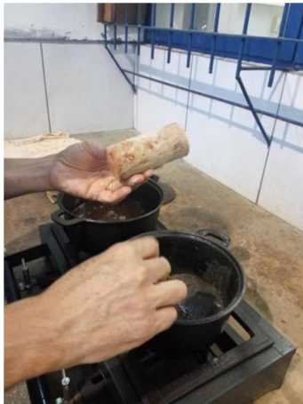
Figura 5.25 - Impermeabilização radial do CP com parafina.
