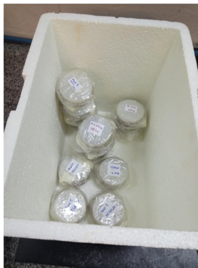
Figura 5.11 - Corpos de provas embrulhados - Técnica papel filtro.
