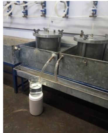
Figura 5.27 - Medição do volume percolado.
