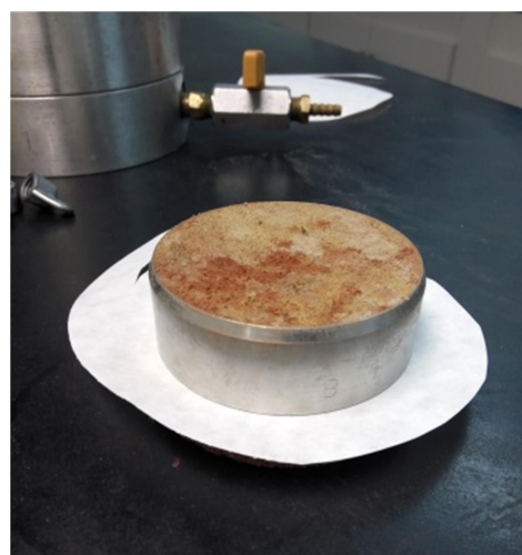
Figura 5.16 - Corpo de prova moldado para o ensaio de compressibilidade.
