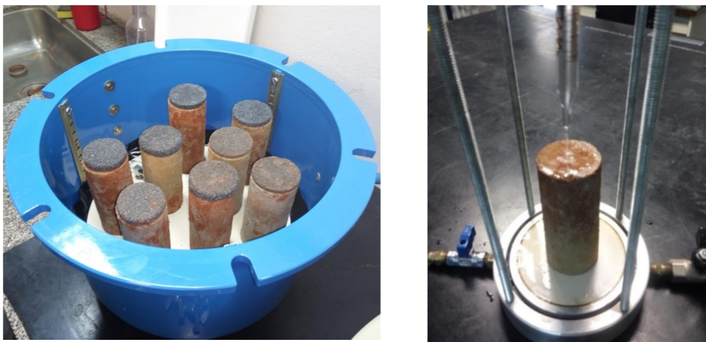
Figura 5.23 - Posicionamento e gotejamento dos CPs na fase de pré-imposição de pressão.
