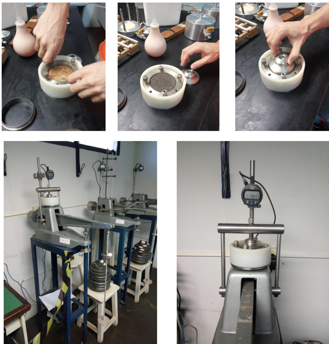
Figura 5.17 - Procedimento de montagem, carregamento e medida da variação axial.
