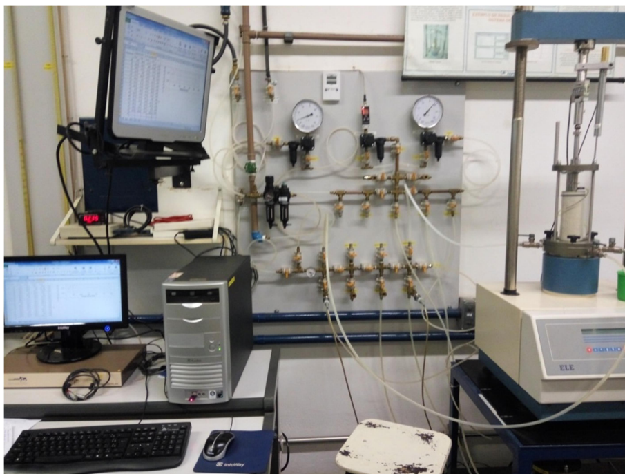
Figura 5.19 - Equipamento triaxial disponível no Laboratório de Mecânica dos solos da UNESP/Bauru.
