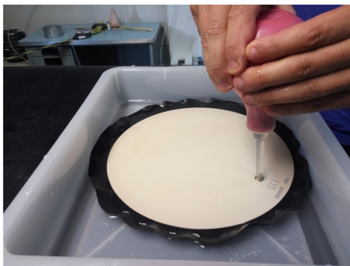
Figura 5.14 - Saturação da placa porosa de alto valor de entrada de ar.
