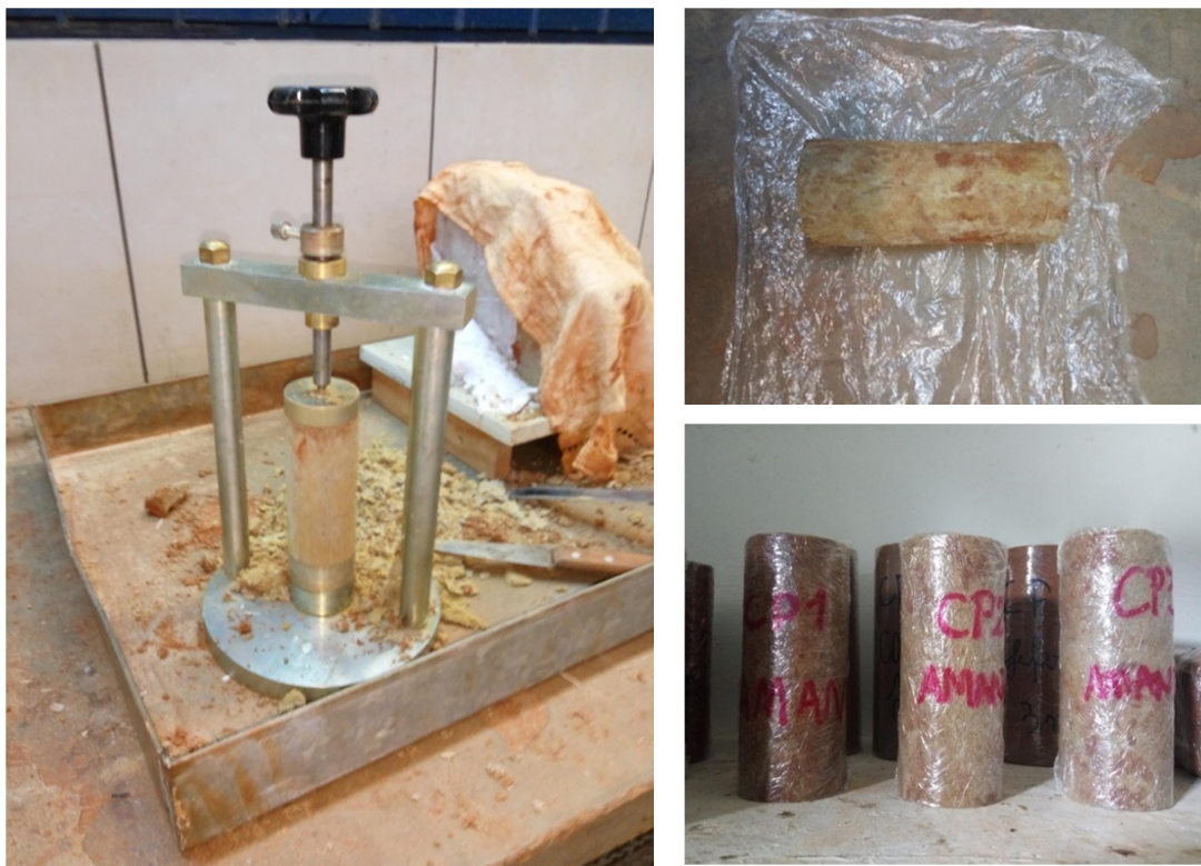
Figura 5.20 - Talhagem, embrulho e identificação do CP para ensaio triaxial.
