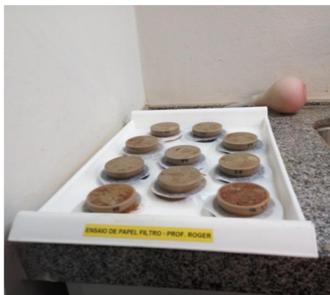
Figura 5.8 - Umedecimento dos CPs por capilaridade
