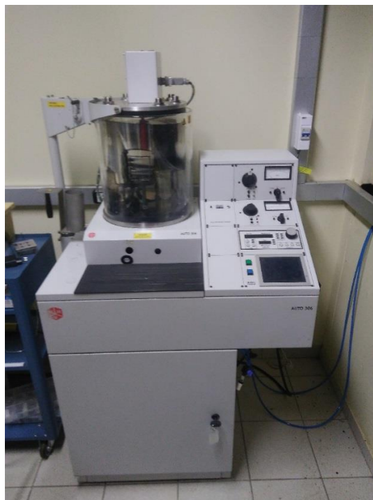
Figura 3-4: Evaporadora de metal Edwards AUTO 306 utilizada na deposição dos eletrodos sobre o filme de ZnO
