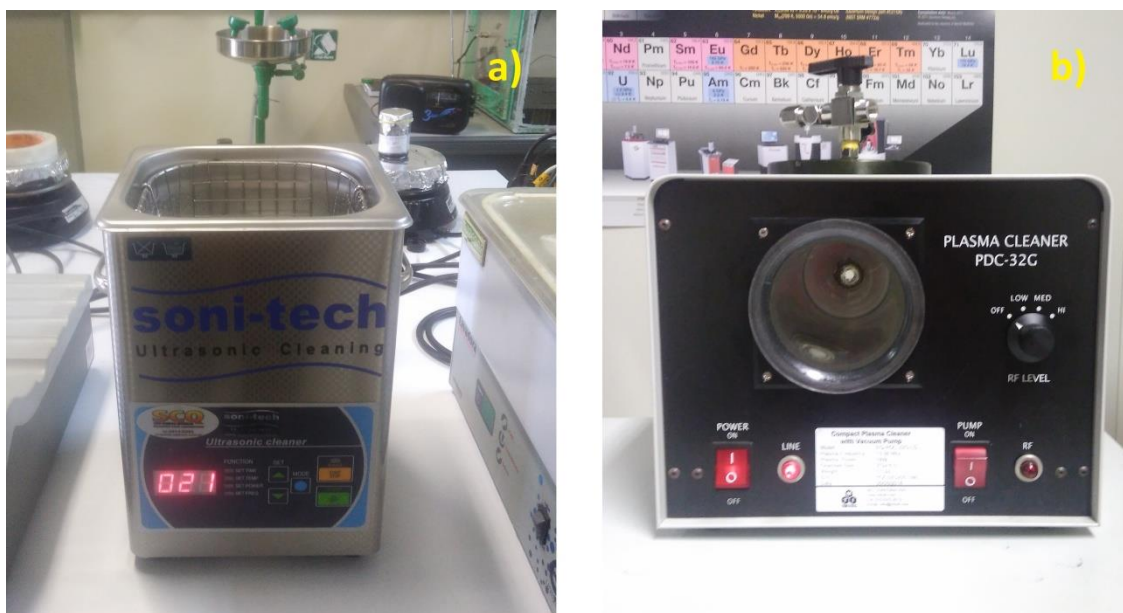
Figura 3-1: a) Equipamento de banho ultrassônico utilizado. b) Limpador plasma utilizado na preparação final dos substratos.
