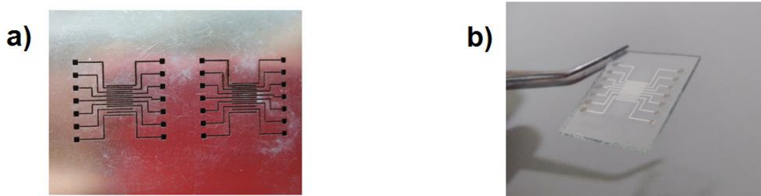
Figura 3-5: a) Máscara utilizada para a deposição dos eletrodos sobre o filme na primeira configuração b) Amostra finalizada.
