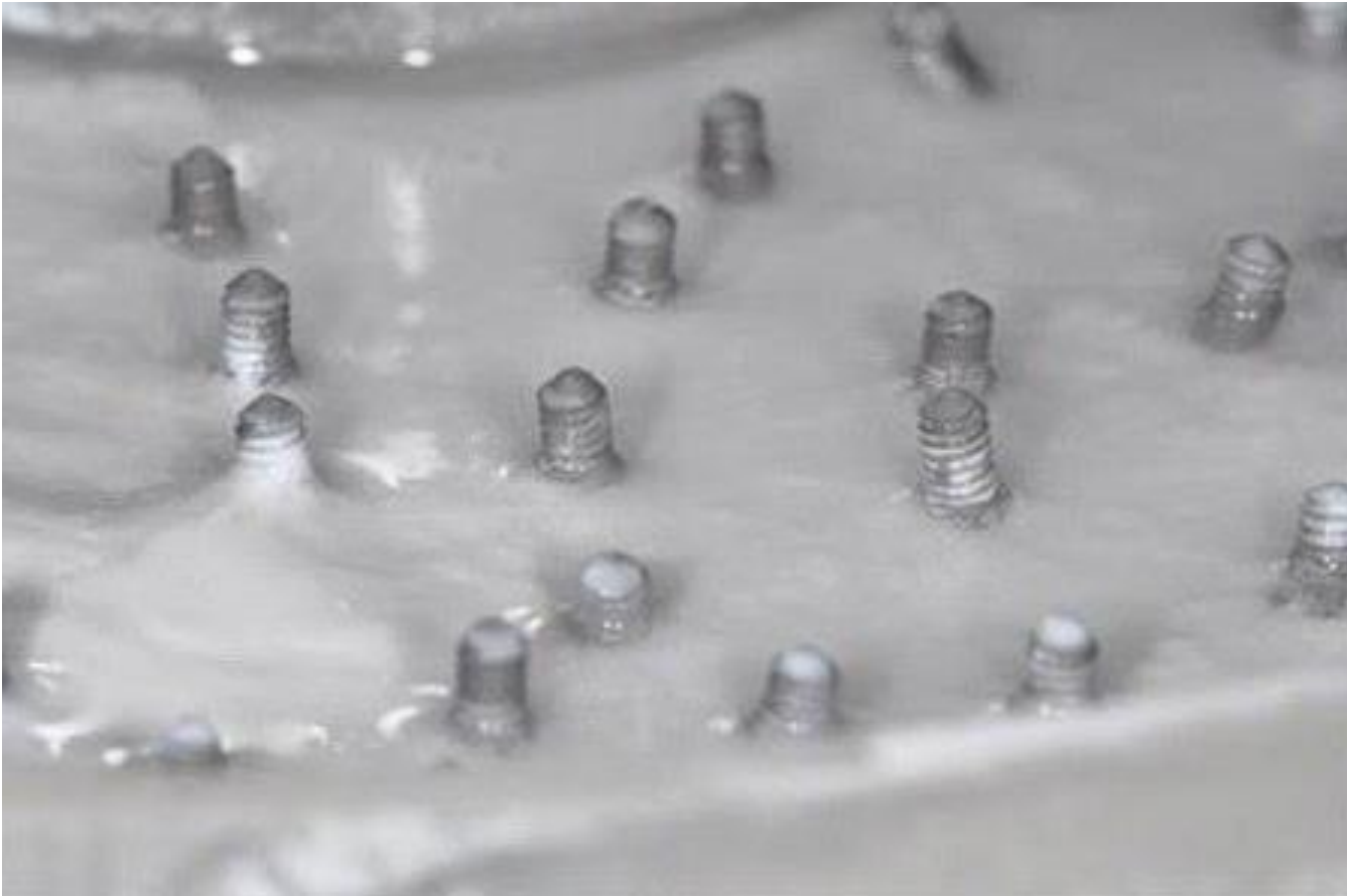
Fig. 3: Implantes imersos em Solução modificada de fluido corporal (Simulated Blody Fluid – SBF) associada ao \beta -tricálcio fosfato (TCP).
