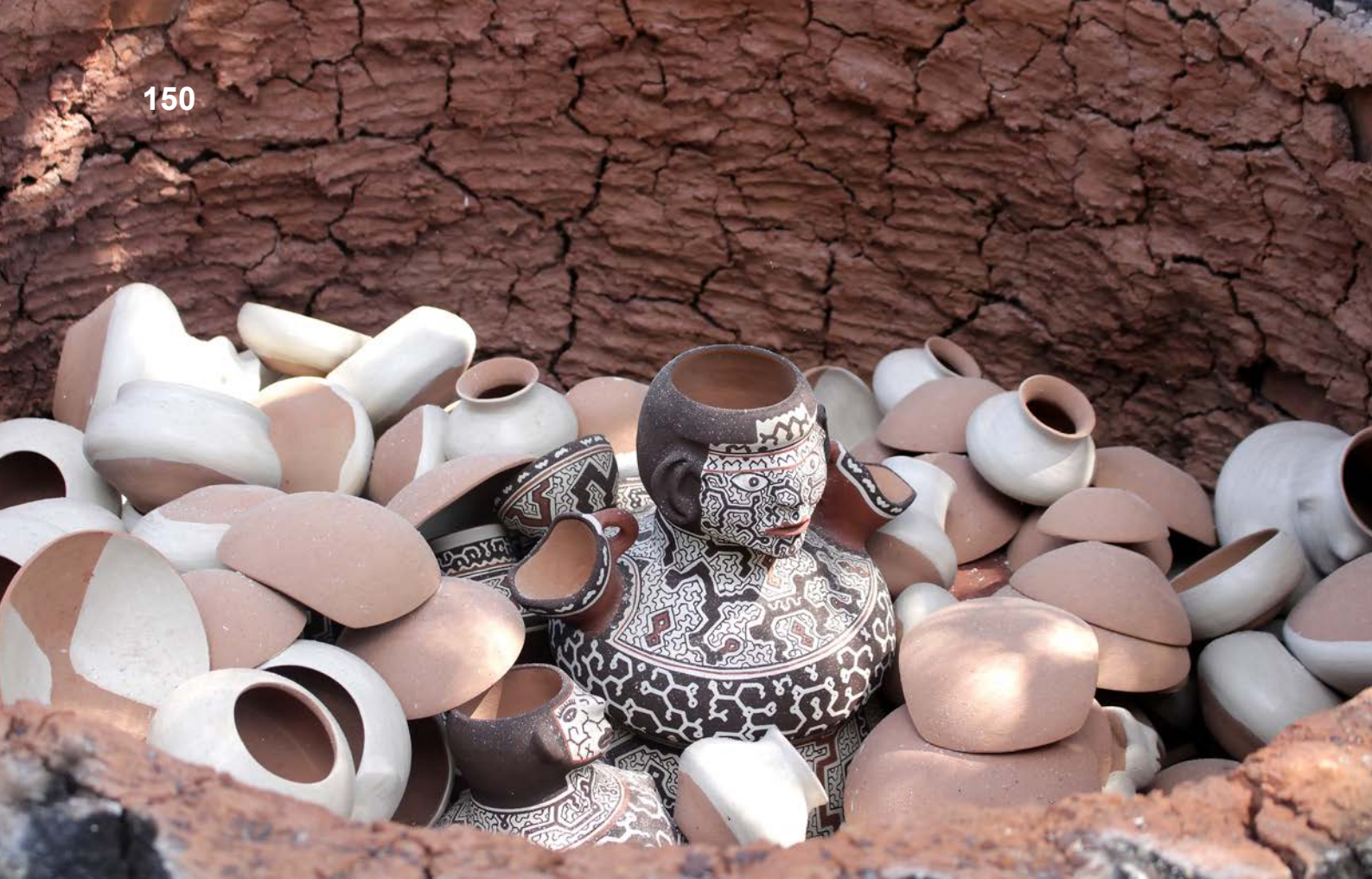
Fig.75 - Abertura do forno, com queima perfeita sem o uso de aparelhos eletrônicos. Pecebe-se a mudança de cores nos engobes. Compare as Figs. 71 e 73. Amazônia, Peru, 2017. Foto da autora.
