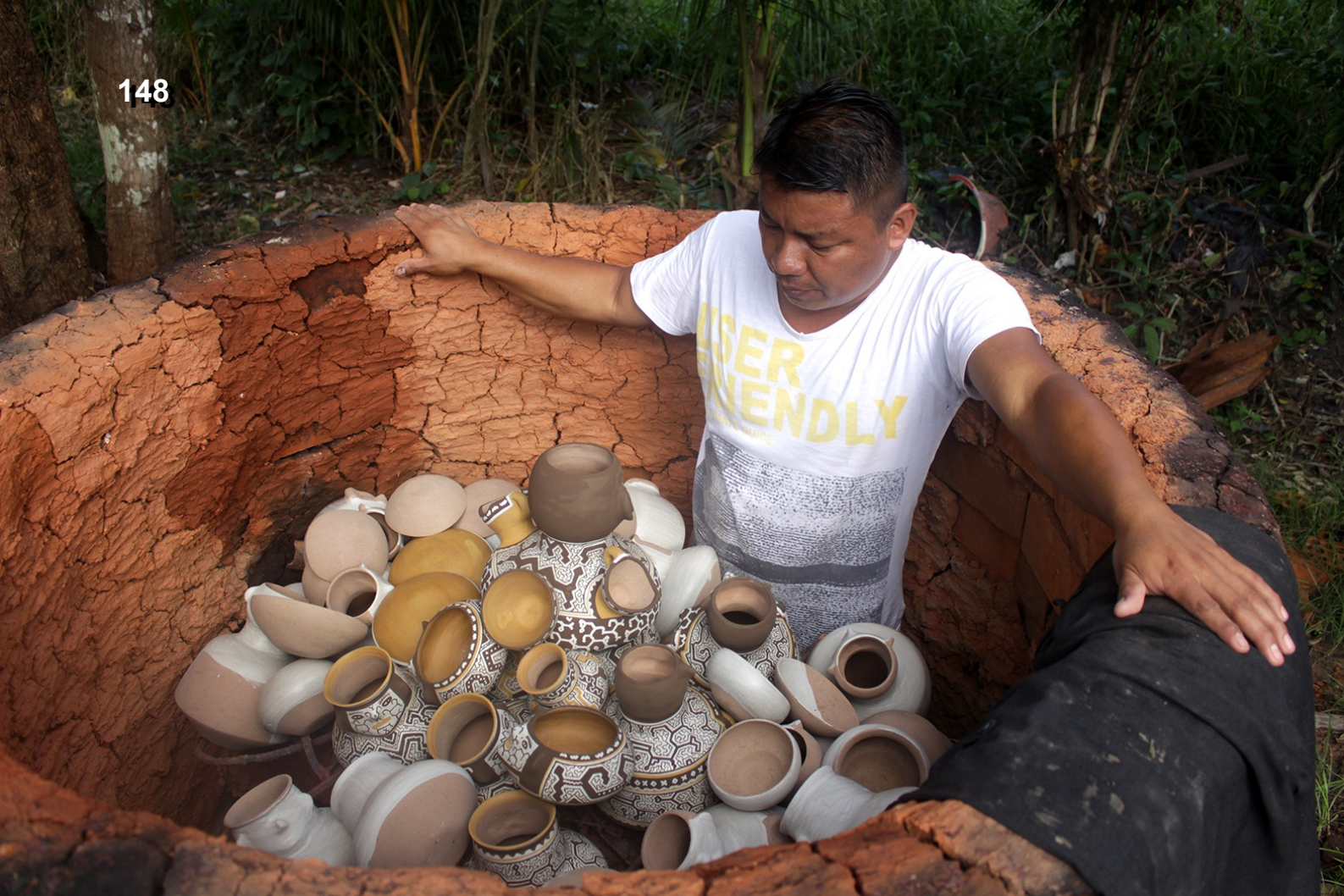
Fig.73 – Oliver Agustin arrumando as peças no forno para a queima. Amazônia peruana. Foto da autora, 2017.
