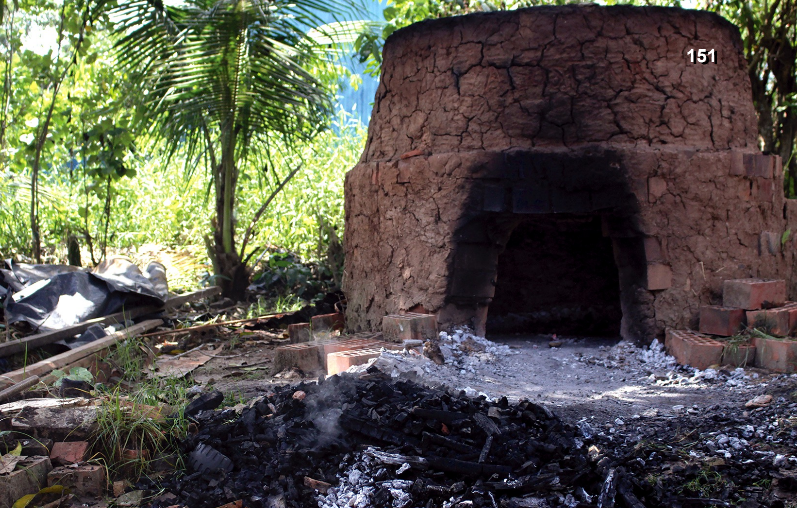
Fig.76 - Abertura do forno com o carvão e as cinzas retiradas com o rodo no final da queima.
