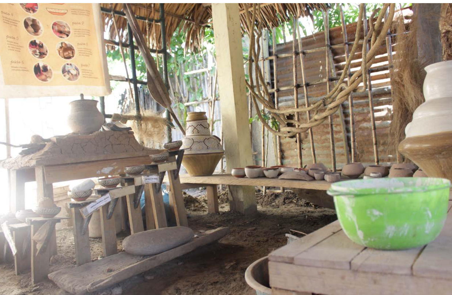
Fig. 116 - Museu Non Axebo. Na foto vemos do lado esquerdo alguns tipos específicos de vasilhas Shipibo e abaixo de cada uma o nome, em Shipibo, correspondente à peça. Logo abaixo, no solo, vemos uma batan (madeira de capirona) que é usada para moer a argila, com uma pedra e temperar com pó de apacharama (cortiça), que dá a leveza nas peças. Ucayali, Amazônia peruana. Foto da autora, 2017.
