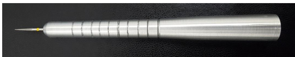
Figura 2 – Simulador de peça de mão em formato reto feito de metal
