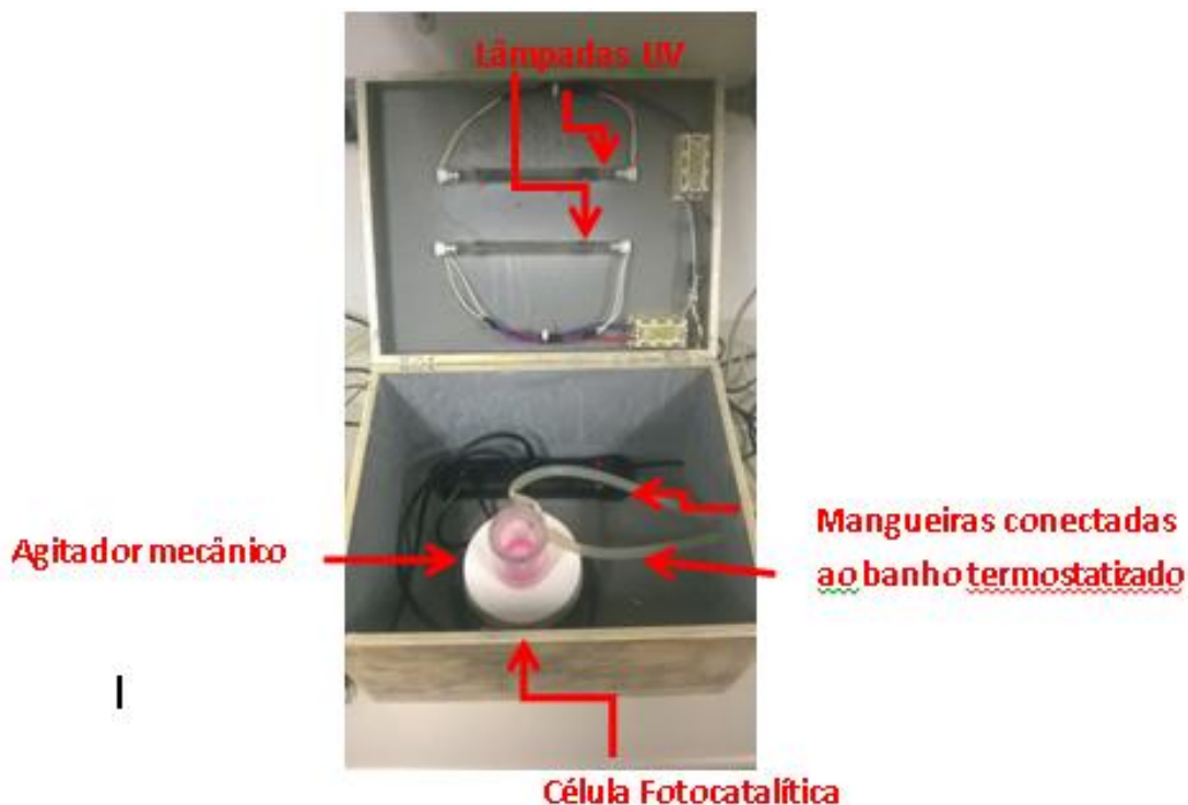
Figura 9: Foto do sistema utilizado para a degradação fotocatalítica. (Fonte: Autoria Própria)
