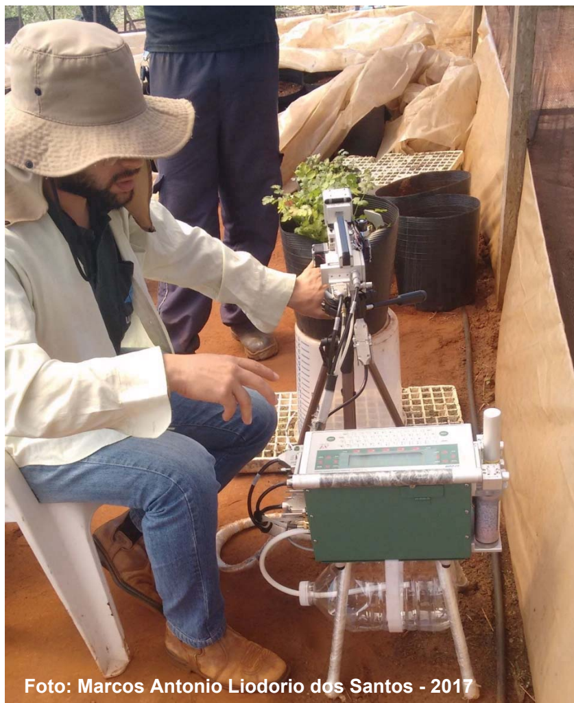
Figura 7 – Avaliação de eficiência fotossintética com - Infra Red Gas Analyse – IRGA, modelo LI-6400, LI-COR
