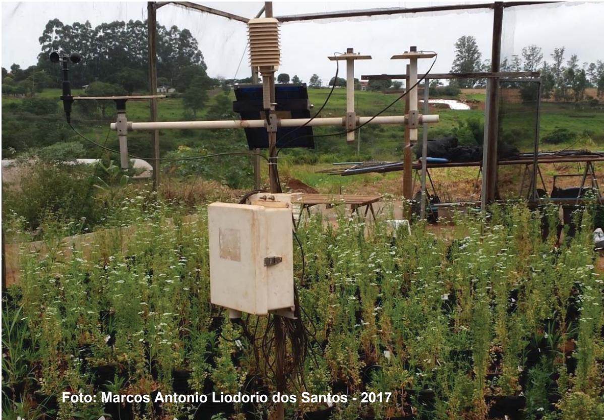
Figura 4 – Estação meteorológica Campbell® modelo CR10X que foi instalada no centro do experimento
