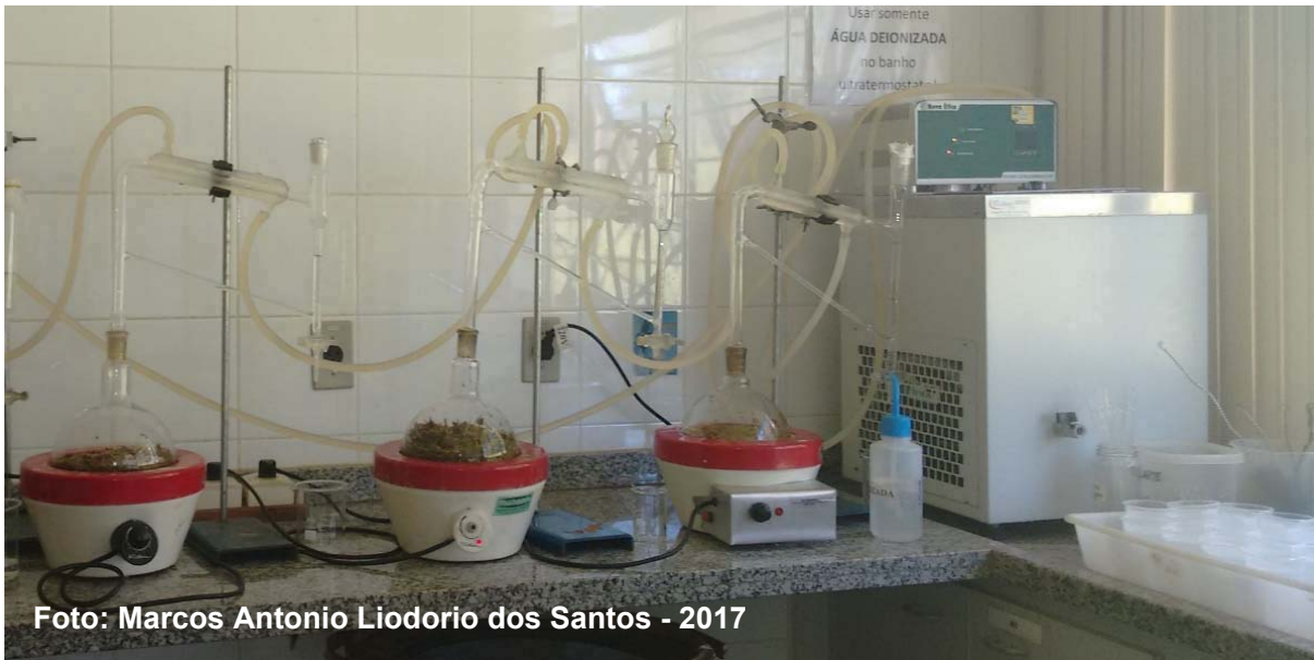
Figura 7 – Extração de óleo essencial utilizando clewenger
