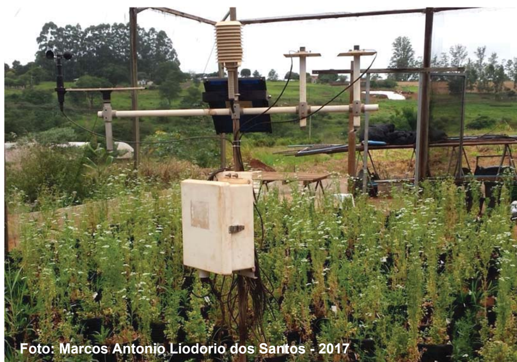
Figura 3 – Estação meteorológica Campbell® modelo CR10X que foi instalada no centro do experimento
