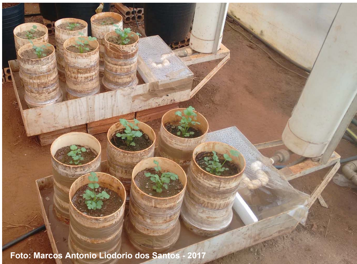
Figura 5 – Lisímetros usados para a mensuração da evapotranspiração da cultura
