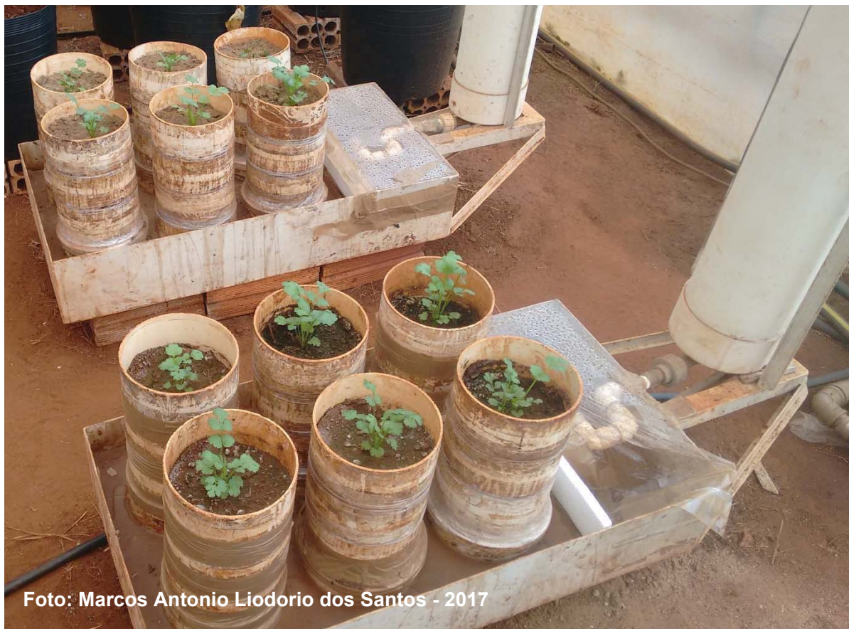
Figura 4 – Lisímetros usados para a mensuração da evapotranspiração da cultura
