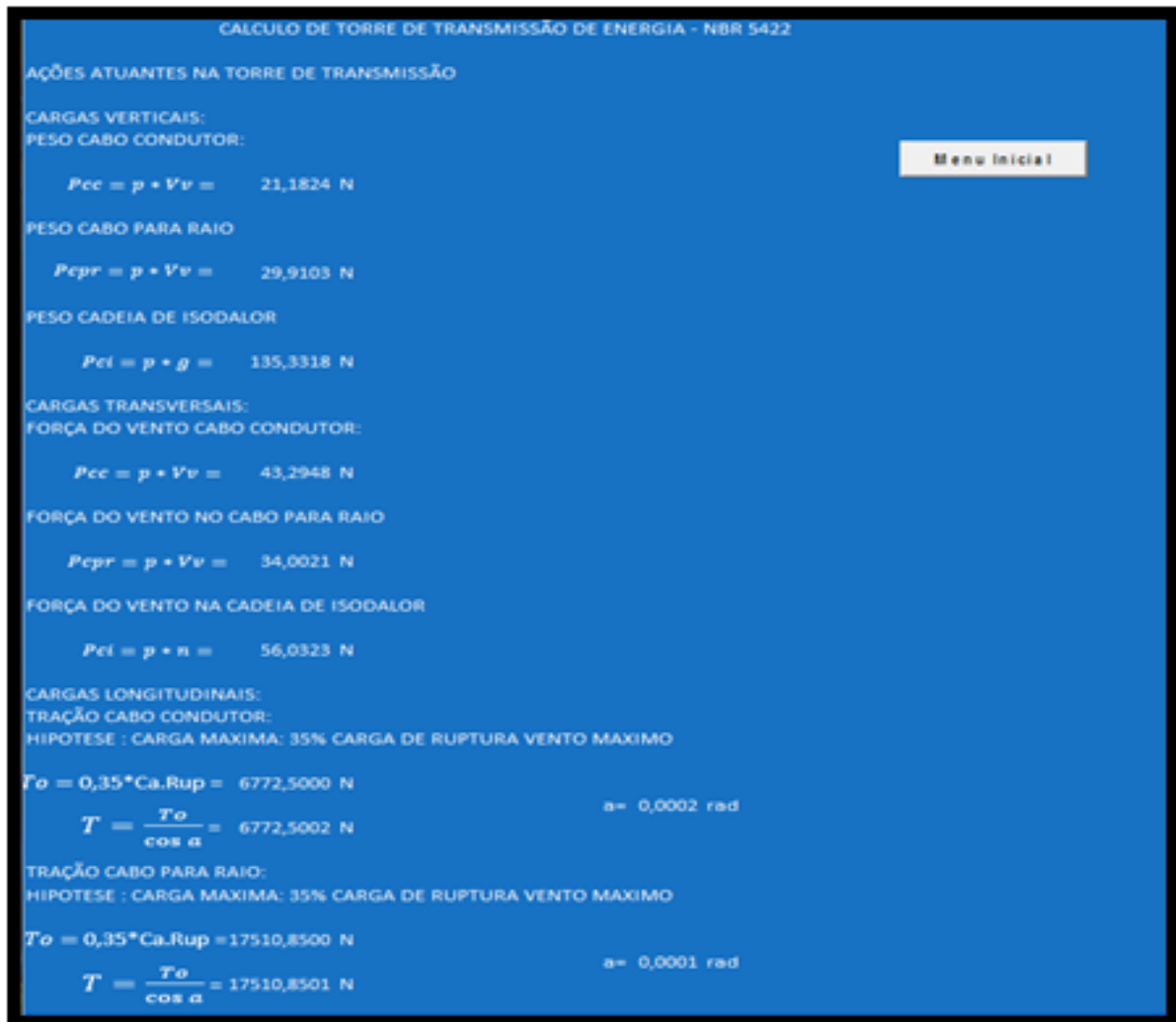
Figura 42 – Cargas nos cabos.
