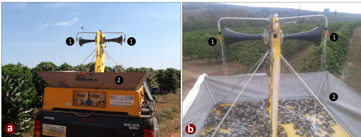
Figura 1. Armadilha sonora usada para a captura de Quesada gigas em lavouras de café. (a) Perspectiva geral da armadilha sonora adaptada a uma pickup. (b) Detalhes da armadilha sonora. (1) Pulverizadores inseticidas a frente do emissor de som; (2) Recipiente para coleta de cigarras mortas e para recirculação da calda inseticida.
