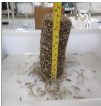
Figura 21 Meio filtrante de bagaço de cana-de-açúcar colocado na coluna de plástico (PVC)
