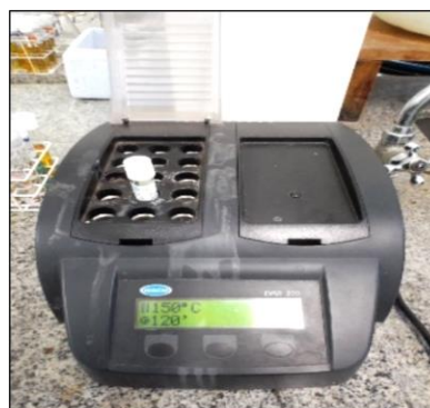
Figura 12 Ensaio para quantificação de sólidos totais (banho maria)
