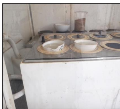
Figura 12 Ensaio para quantificação de sólidos totais (banho maria)
