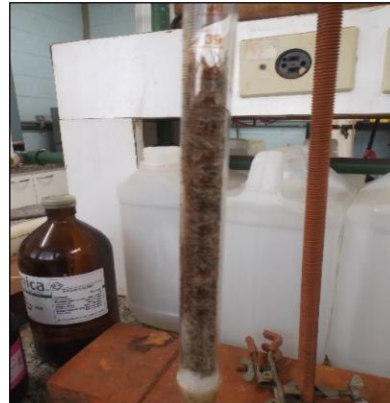
Figura 18 Meio suporte de lá de vidro colocado em coluna de vidro (bureta)
