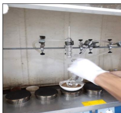
Figura 11 Ensaio para quantificação de O&G. (Soxhlet)
