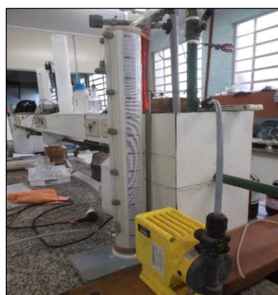
Figura 24 Montagem experimental de coluna de plástico (PVC)
