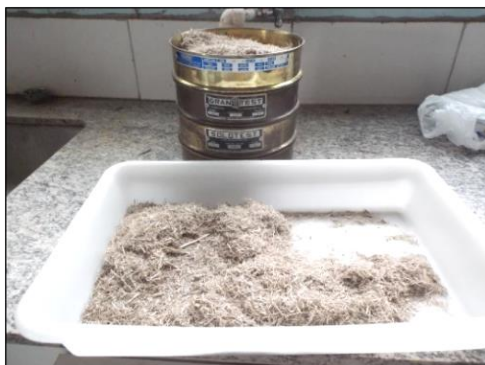
Figura 5 Ensaio de peneiramento por peneira padronizada tipo Tyler de bagaço cana-de-açúcar
