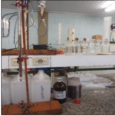
Figura 17 Montagem experimental de coluna de vidro (bureta)
