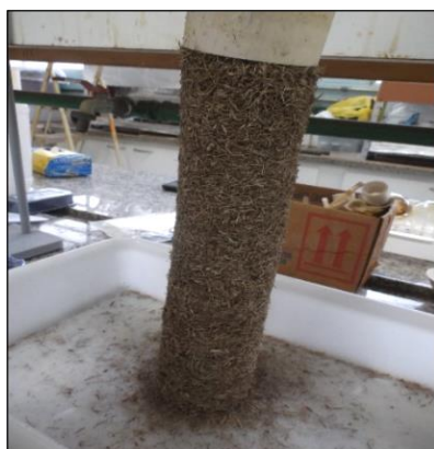
Figura 23 Meio filtrante de bagaço de cana-de- açúcar moldada na coluna plástica (PVC)
