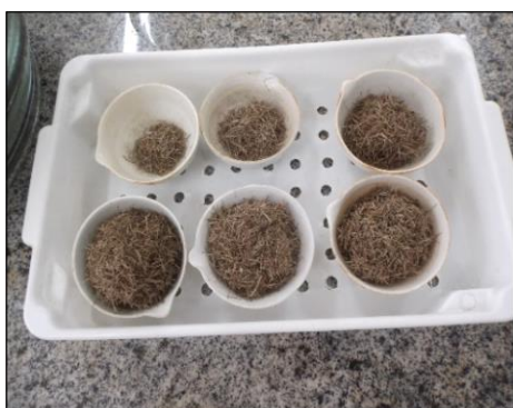
Figura 13 Massas de bagaço de cana-de-açúcar por pesagem em capsulas
