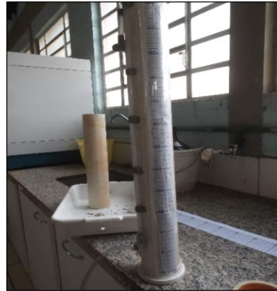
Figura 20 Piezômetros colocados em coluna plástica (PVC)
