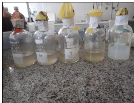
Figura 16 Alíquotas de solução sintética obtidas em ensaios de batelada
