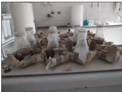
Figura 15 Aspectos dos ensaios em mesa agitadora com soluções sintética e massas de bagaço de cana-de-açúcar
