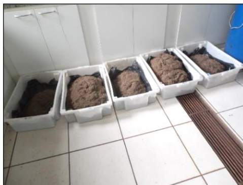
Figura 6 Amostras de bagaço de cana-de-açúcar classificadas depois dos ensaios de peneiramento
