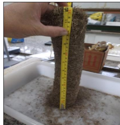
Figura 22 Medição da altura do meio filtrante de bagaço-de-cana-de- açúcar colocada em coluna plástica (PVC)
