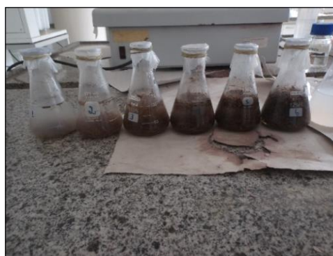
Figura 14 Frascos com solução sintética e bagaço de cana-de-açúcar
