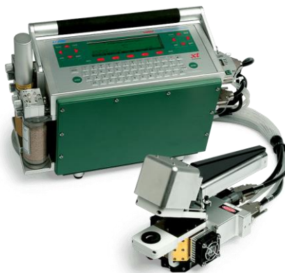
Figura 8. Medidas de trocas gasosas em plantas de cafeeiro com IRGA LI-COR 6400
