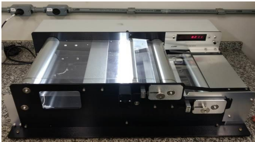
Figura 7. Integrador de área foliar utilizado nos experimentos
