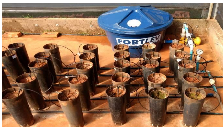
Figura 5. Sistema de irrigação por gotejamento utilizado no cafeeiro
