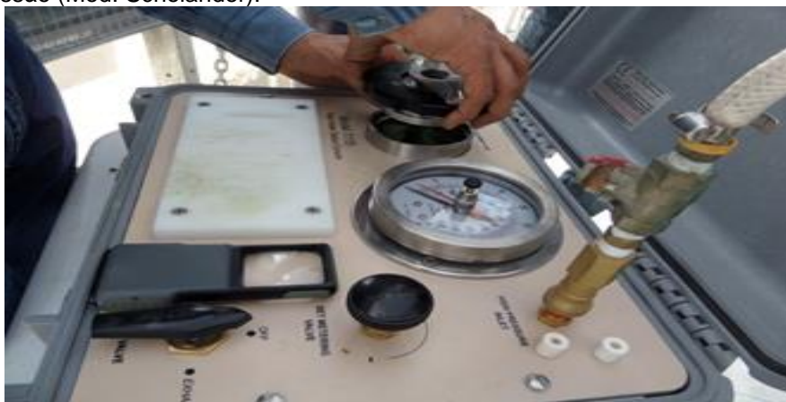
Figura 6. Medidas do potencial hídrico foliar no cafeeiro efetuado antes do amanhecer com auxílio da bomba de pressão (Mod. Scholander).
