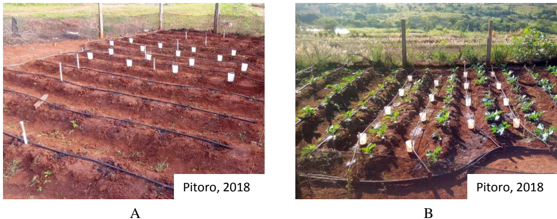
Figura 17 – Coleta de amostras da vazão aplicada
