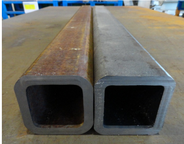
Figura 18 - Tubos utilizados na pesquisa com dimensão nominal de 80x80x10 mm
