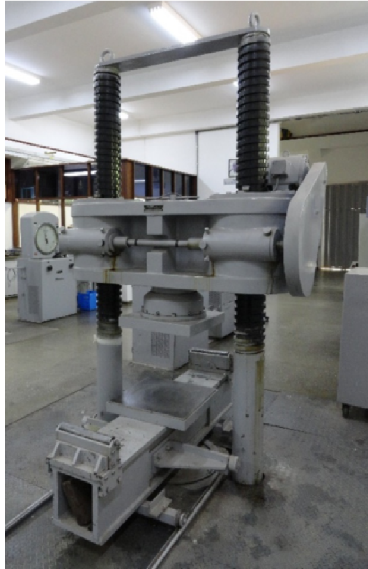
Figura 32 - Prensa MARUTO utilizada no ensaio de compressão
