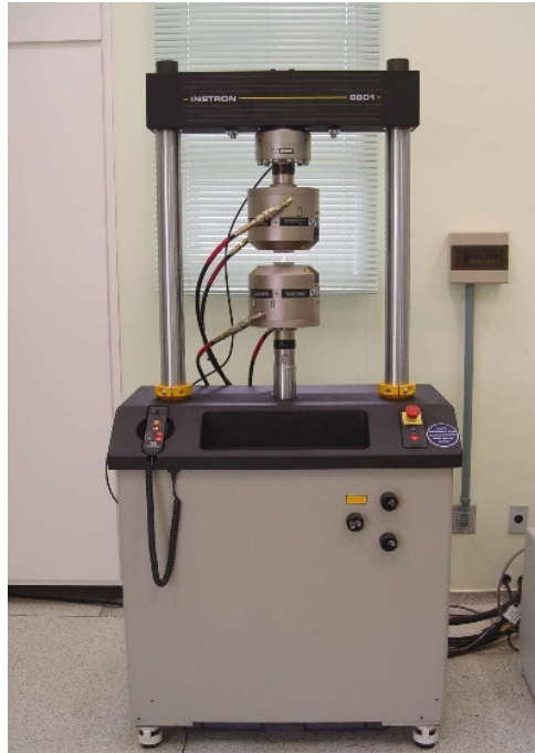
Figura 30 - Equipamento servo-hidráulico de ensaios mecânicos Instron 8801
