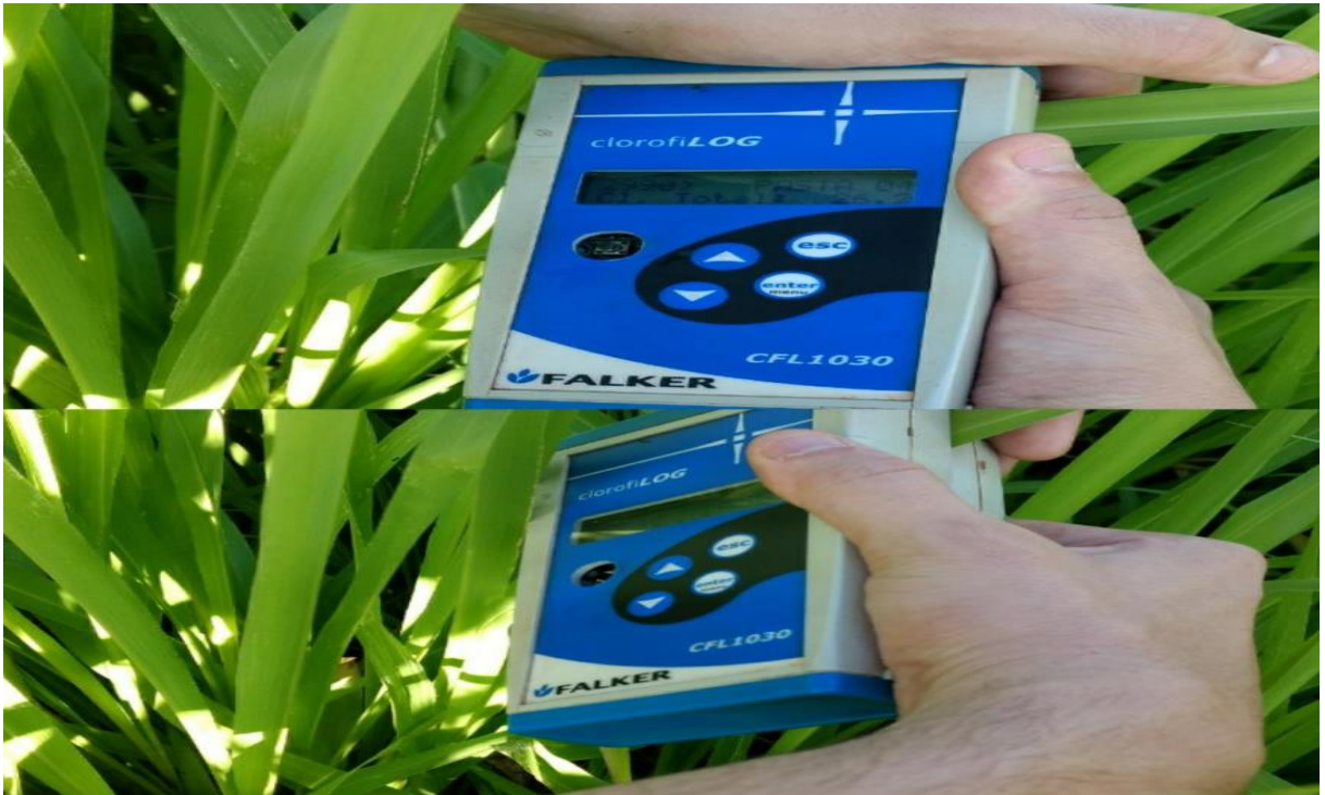
Foto 8 – Leitura do índice de clorofila foliar a partir do clorofilômetro ClorofiLOG Falker
