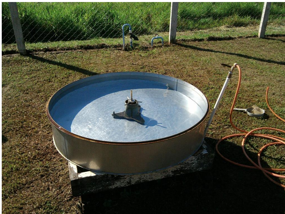
Figura 26- Tanque Classe A instalado na FEPE – Fazenda de Ensino, Pesquisa e Extensão da UNESP de Ilha Solteira, utilizado nas aferições diárias de Evaporação próximos à área experimental. Selvíria – MS, 2015.
