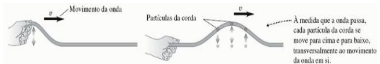
Figura 8 - Onda transversal em uma corda
