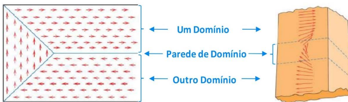
Figura 4 - Esquemática dos múltiplos domínios magnéticos e suas paredes.
