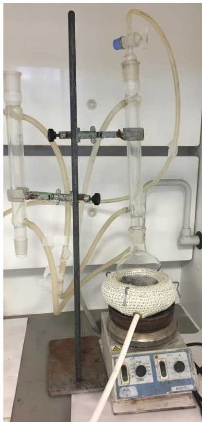
Figura 10 - Sistema para a ebulição do resíduo insolúvel com 100 ml de KOH 4M
