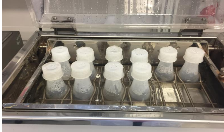
Figura 12 - Amostras do ensaio de pH e condutividade elétrica no banho térmico
