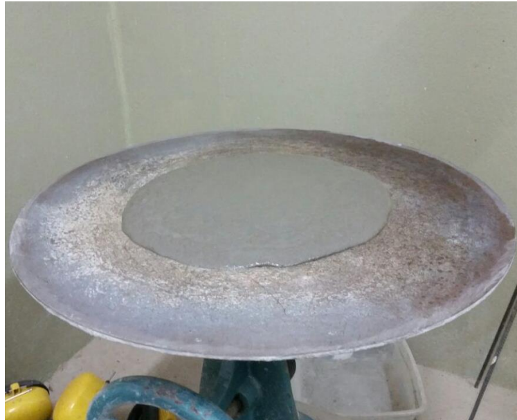
Figura 17 - Representação do ensaio de índice de consistência
