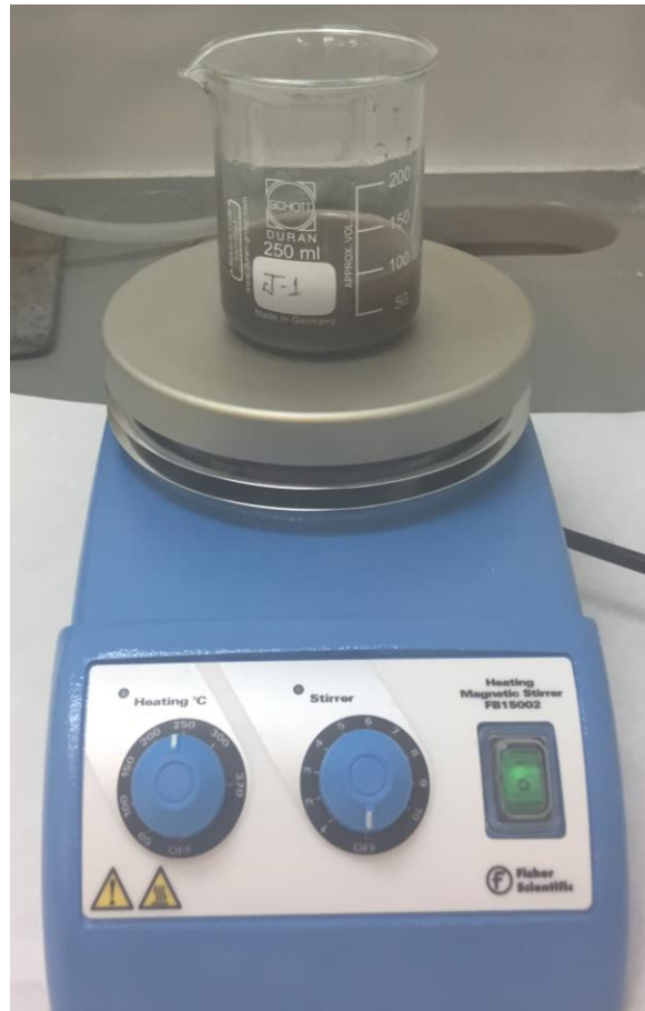
Figura 9 - Mistura de CFB + 75 mL de HCl 3M na placa aquecedora
