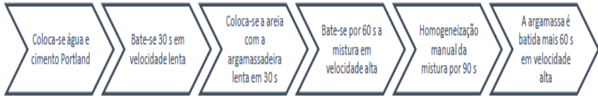
Figura 16 - Ordem de mistura das argamassas
