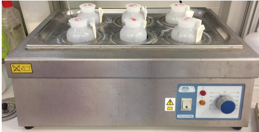
Figura 14 - Amostras do ensaio de Frattini
