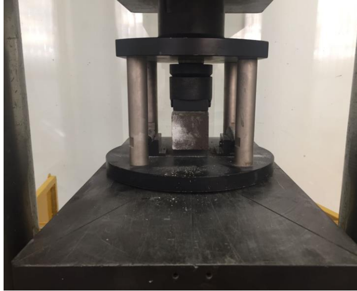
Figura 19 - Corpo de prova posicionado para o ensaio de resistência à compressão
