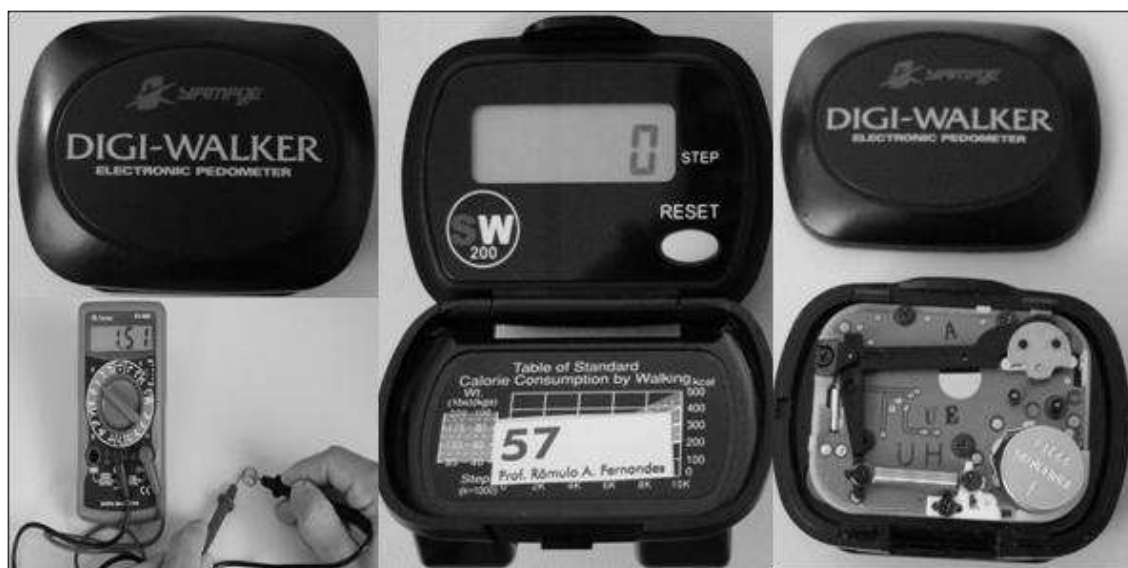
Figura 2. Verificação das peças internas do pedômetro e da carga da bateria previamente à entrega ao participante da pesquisa.
