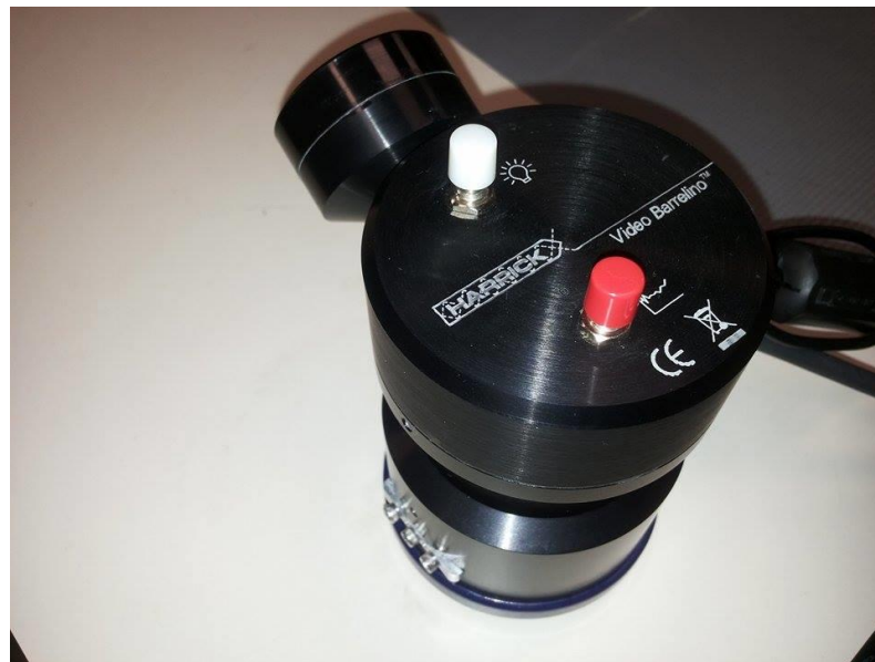
Figura 4: Sistema de vídeo Barrelino® utilizado para medir refletância em sólidos.
