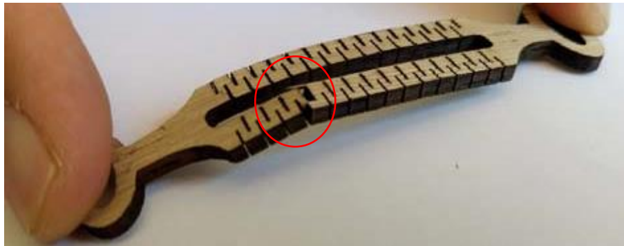
Figura 106 — Fissura apresentada na peça
