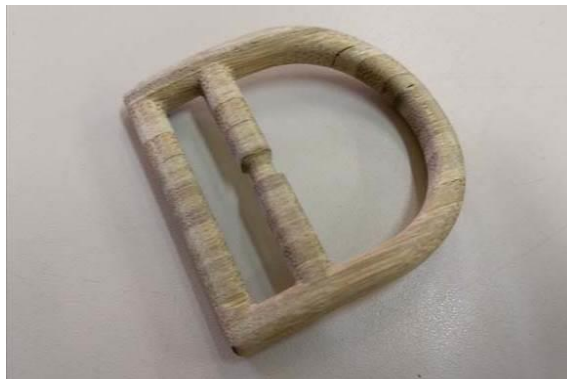
Figura 94 — Acessório em BLC feito em CAD/CAM
