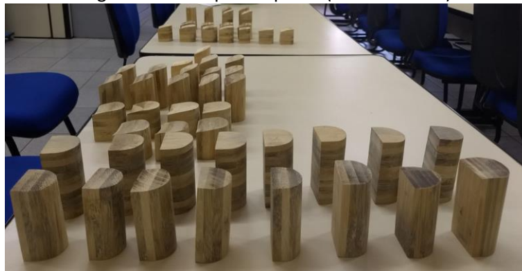
Figura 90 — Corpos de prova (saltos em BLC)
