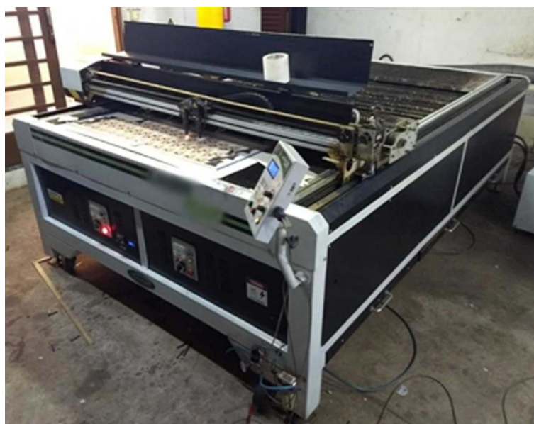
Figura 10 — Máquina de corte a laser - Marca Futurize - DJ-6040 - Potência 150 W
