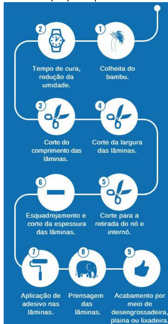
Figura 63 — Etapas para o processamento do BLC
