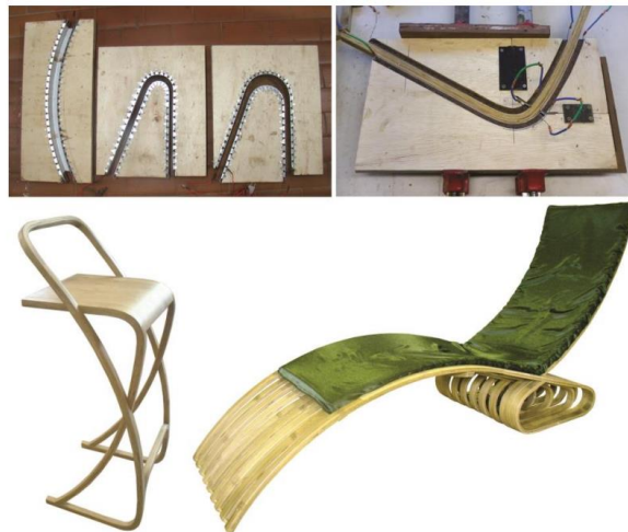
Figura 65 — Moldes e protótipos em BLC
