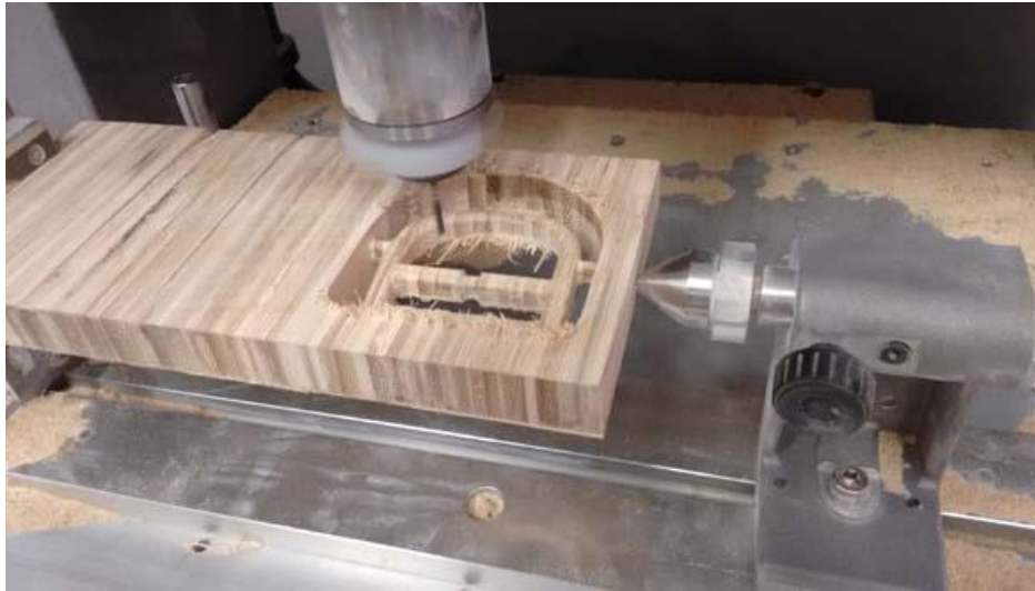
Figura 93 — Tecnologia subtrativa em operação
