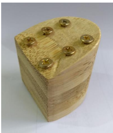
Figura 4 — Fixação de parafusos ABNT NBR 15195:2015
