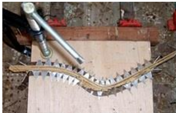
Figura 97 — Molde para BLC curvado
