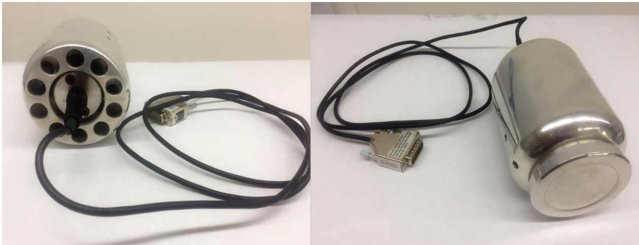
Figura 12. Transdutor de torque portátil acoplado ao mock-up utilizado para transmissão de força.
