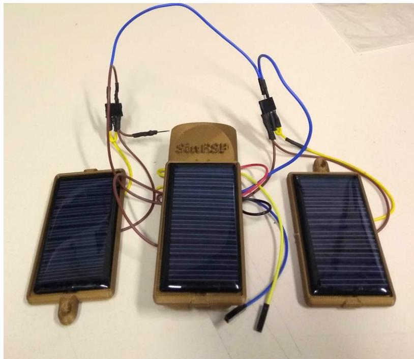
Figura 16. Dispositivo modular operando com três células de 5v e 60mah
