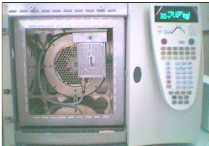
Figura 29 - Módulo de aquecimento ultrarrápido instalado no forno de um cromatógrafo convencional.
