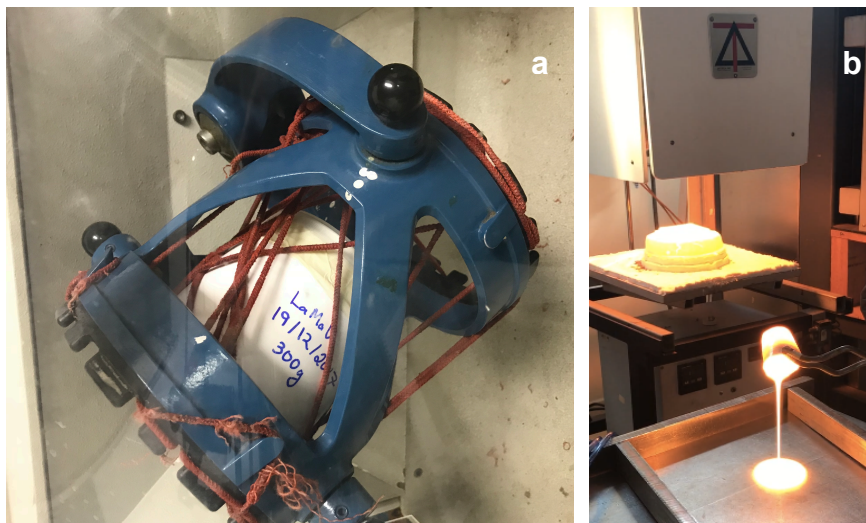
Figura 3 – a) Homogeneização dos reagentes; b) Fusão da vitrocerâmica
