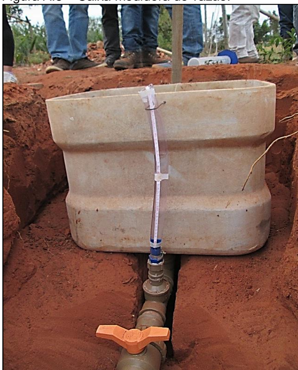
Figura A.5 – Caixa medidora de vazão.
