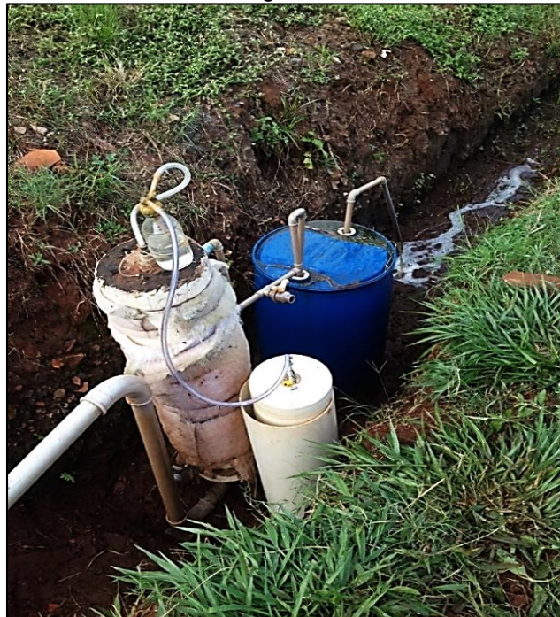
Figura 2.2 – Reator UASB de baixo custo instalado na Fazenda Lageado em Botucatu/SP.
