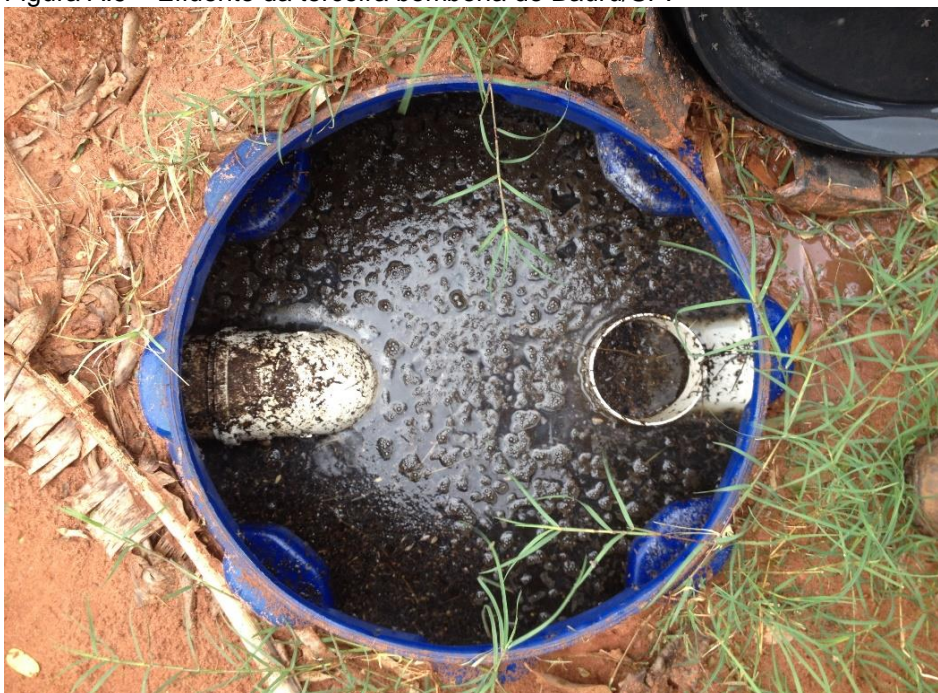
Figura A.9 – Efluente da terceira bombona de Bauru/SP.
