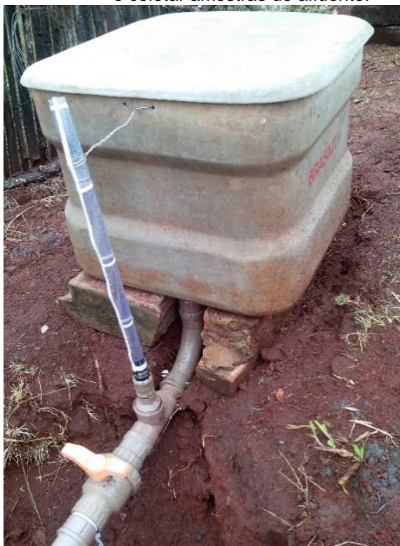
Figura 2.3 – Caixa utilizada para medir a vazão e coletar amostras do afluente.
