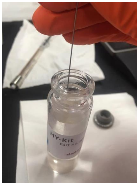
Figura 7 – Impermeabilização da agulha utilizando uma solução hidrofóbica
