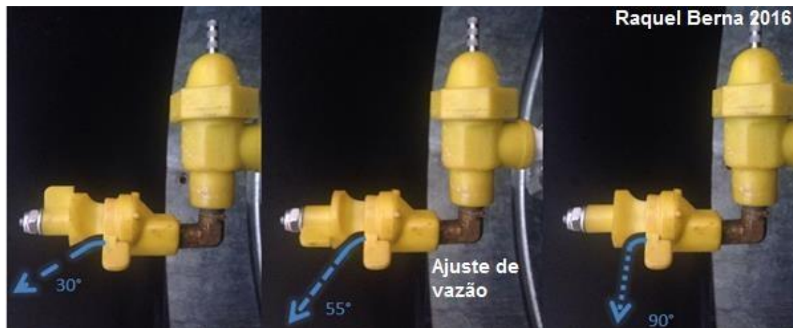
Figura 3 – Descrição do bico de pulverização (CP 03) e ilustração dos ângulos defletores
