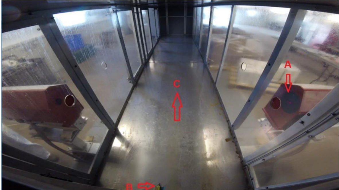
Figura 2 – Túnel de vento de alta velocidade para simulação de aplicações aéreas. Laser Sympatec HELOS/VARIO KF (A), ponta CP-03 (CP Products Company) (B) e direcionamento do vento dentro da câmara (C)
