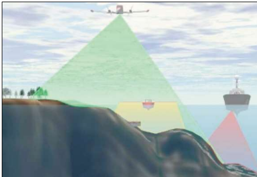
Figura 1 – Capacidades de levantamento de um sistema ALB.
