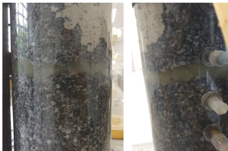
Figura 14: Fotos da Manta de lodo no reator UASB (fase 6).
