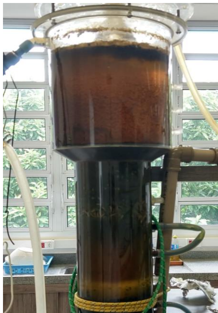
Figura 13: a) Proliferação de algas no interior do reator UASB; b) Reator após limpeza.
