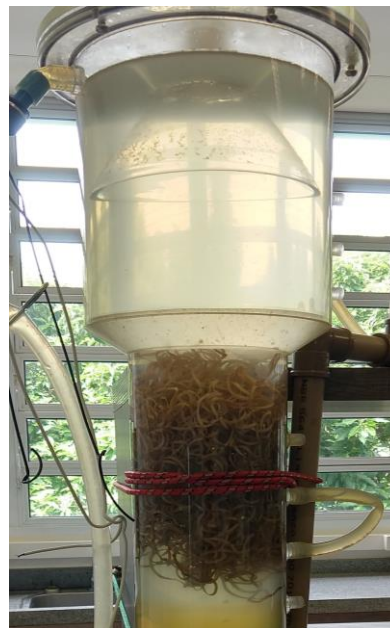
Figura 13: a) Proliferação de algas no interior do reator UASB; b) Reator após limpeza.
