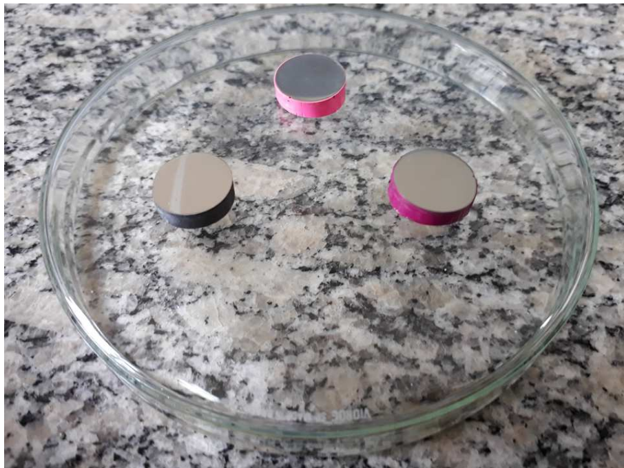
Figura 3.1.2 – Corpos-de-prova confeccionados para os ensaios de corrosão e metalográficos.
