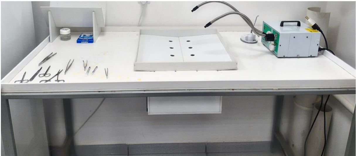
Figura 3. Mesa cirúrgica com sistema de recirculação de água e benzocaína. Fonte: elaborada pela autora.
