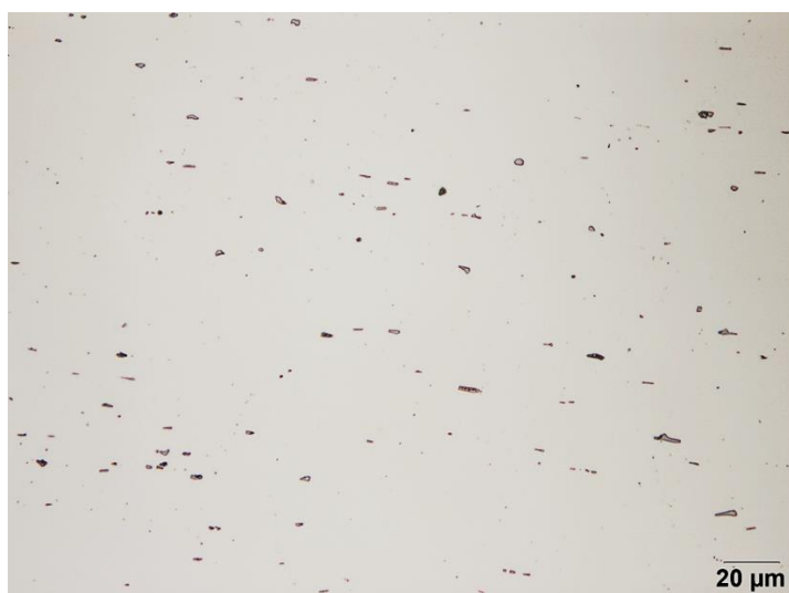
Figura 4 – Detalhes da microestrutura e distribuição homogênea das partículas de segunda fase \alpha -AlFeSi, nota-se poucos precipitados Mg 2 Si após envelhecimento artificial condição típica promovendo boas propriedades mecânicas.
