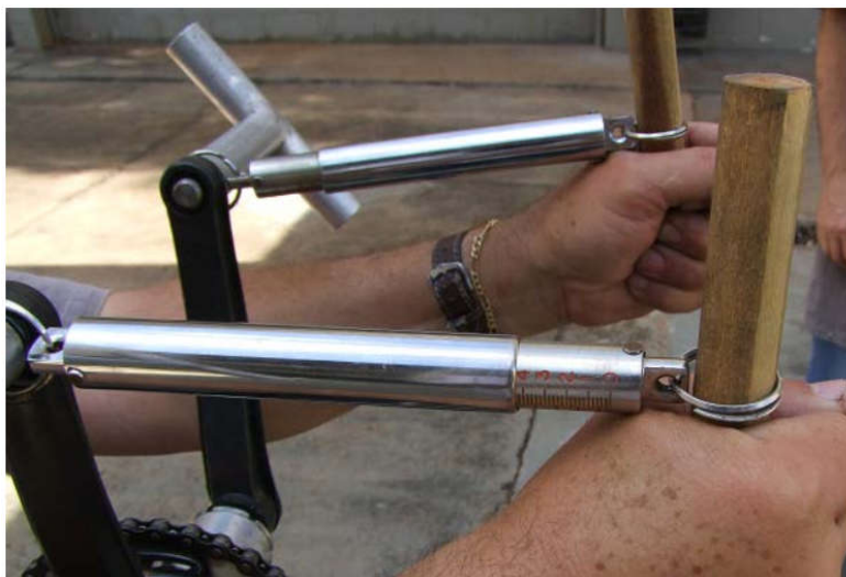
Figura 8 - Ensaio experimental para obtenção da força de acionamento dos pedais.
