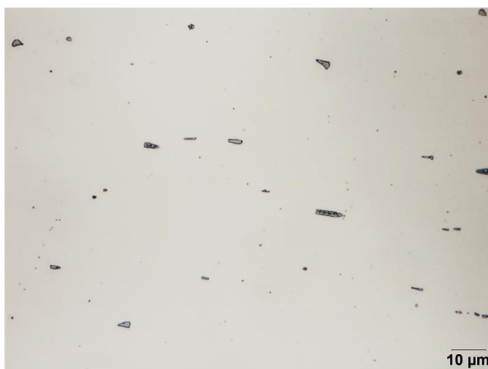
Figura 4 – Detalhes da microestrutura e distribuição homogênea das partículas de segunda fase \alpha -AlFeSi, nota-se poucos precipitados Mg 2 Si após envelhecimento artificial condição típica promovendo boas propriedades mecânicas.
