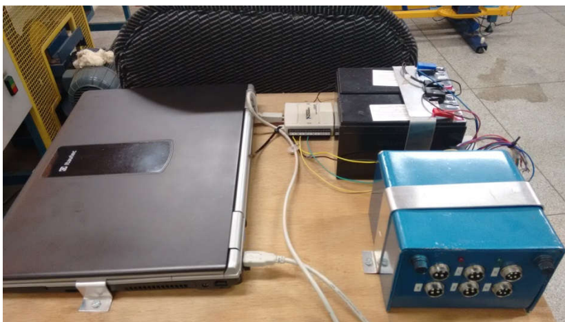
Figura 30 - Bancada de instrumentação fixada na traseira do triciclo híbrido.
