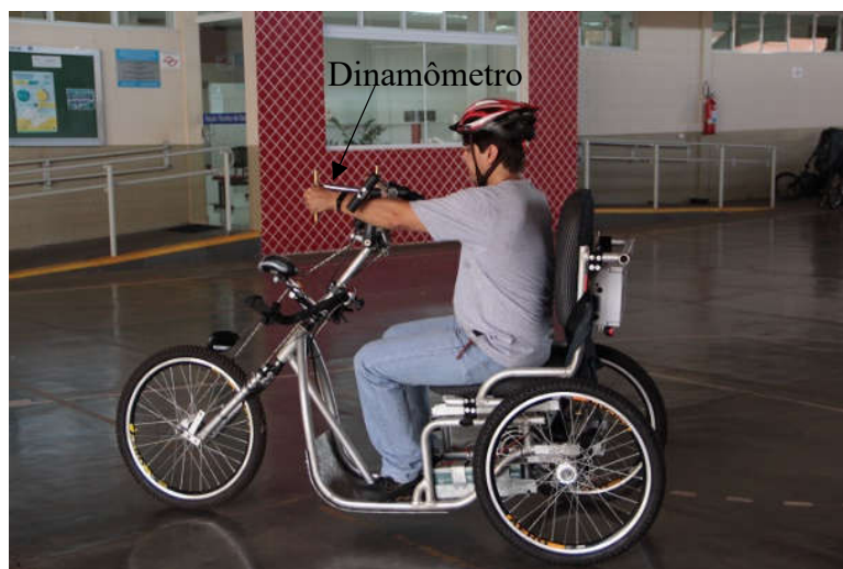
Figura 20- Ensaio para obtenção da força de acionamento cíclico manual do triciclo híbrido.
