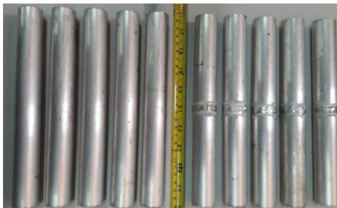
Figura 37- Corpos de prova de tubos de liga de alumínio 6063-T5 com solda (direita) e sem solda (esquerda) encaminhados à CBA. Comprimento 250 mm.
