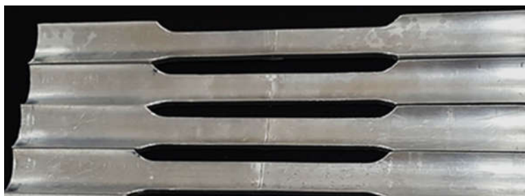
Figura 38- Tubo soldado, face voltada para o interior do tubo.
