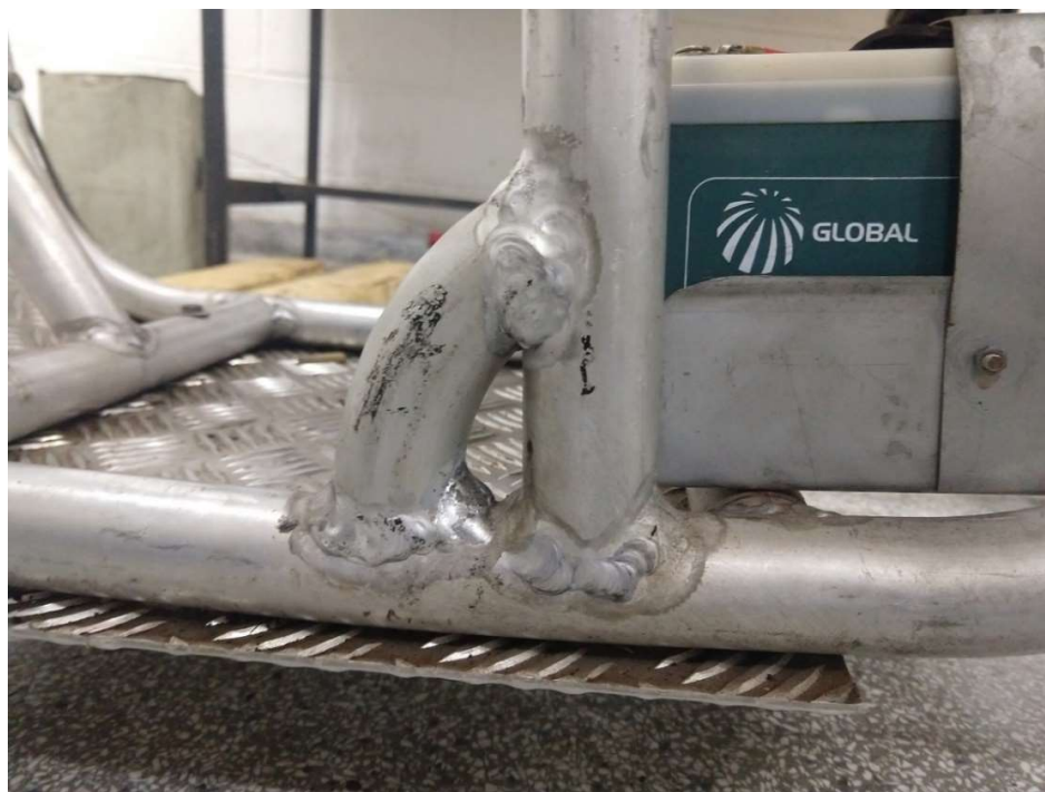
Figura 54 - Cordões de solda na região de maior concentração de tensão no chassi da estrutura tubular de Al 6063-T5.
