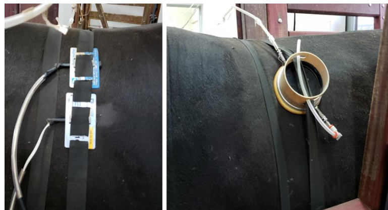
Figura 7. Sensores de temperatura da epiderme, pelame e cápsula ventilada.
