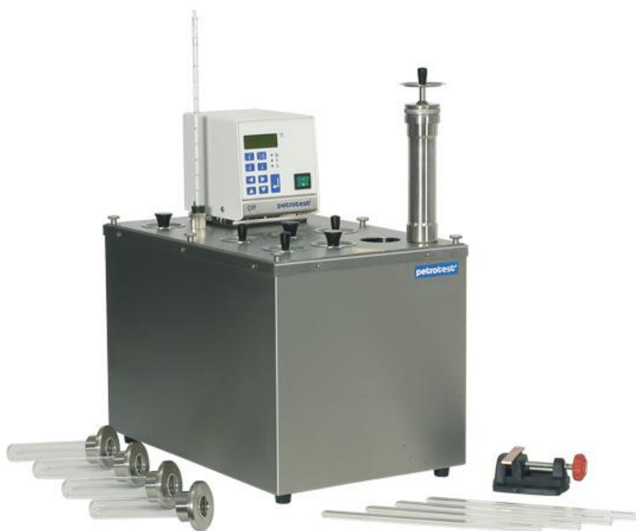
Figura 35. Aparato para teste de corrosão ao cobre.
