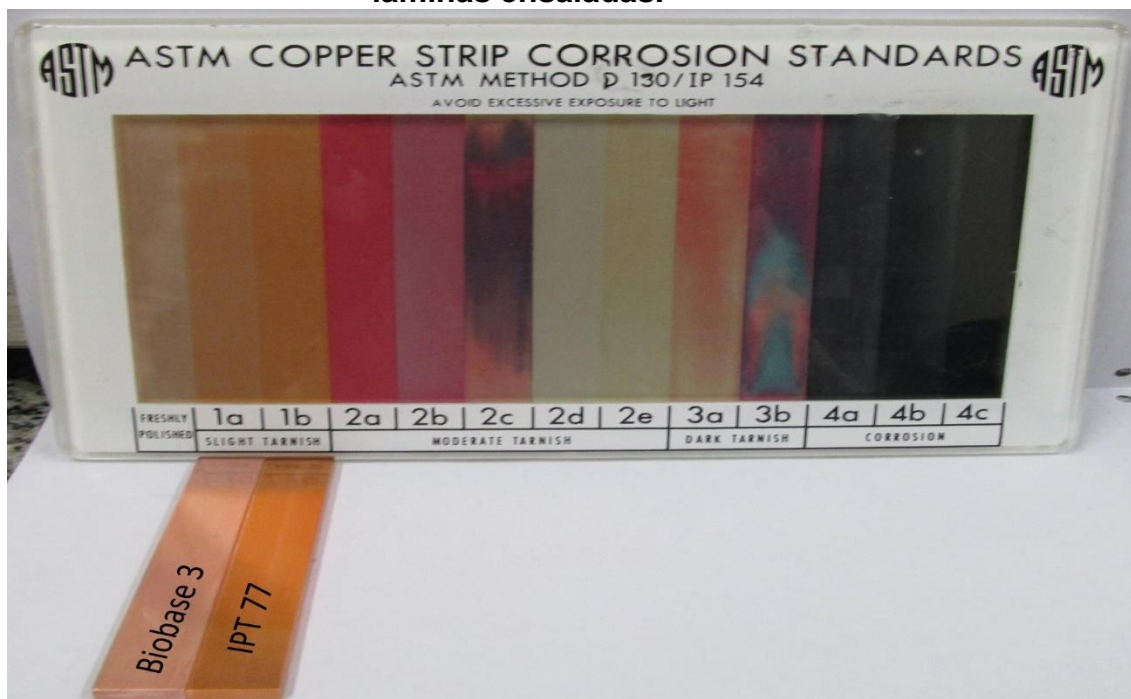
Figura 67. Conjunto de padrões de corrosão à lâmina de cobre da ASTM D130 e laminas ensaiadas.
