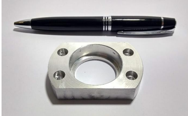
Figura 13 - Mancal de alumínio alojamento para o rolamento de rolos cônicos.
