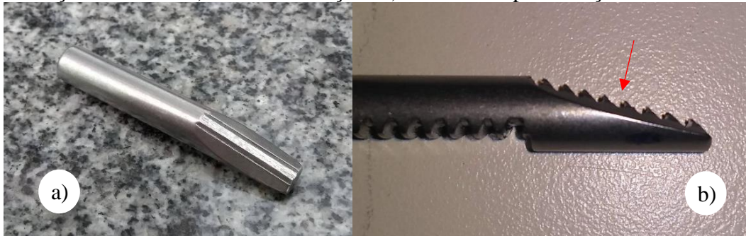
Figura 17 - Pinça do mandril a) sem modificações b) com dentes para fixação axial.
