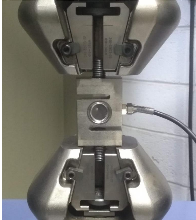
Figura 37 - Célula de carga fixada às garras para a realização da calibração.
