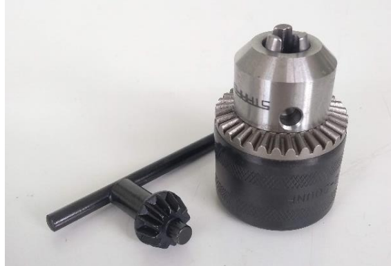
Figura 16 - Mandril de 3/4" da marca Starfer utilizado para confecção das garras.
