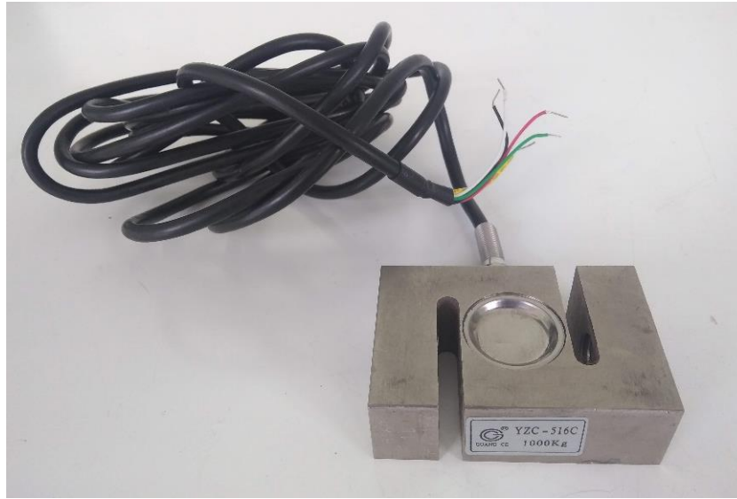
Figura 24 - Célula de carga de 10 kN no projeto para a medição das forças.
