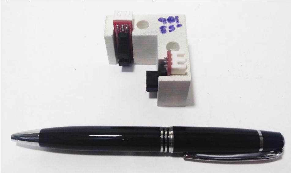
Figura 30 - Suporte para chaves ópticas com 85° impresso em ABS.
