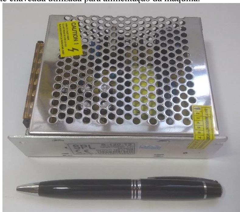
Figura 34 - Fonte chaveada utilizada para alimentação da máquina.
