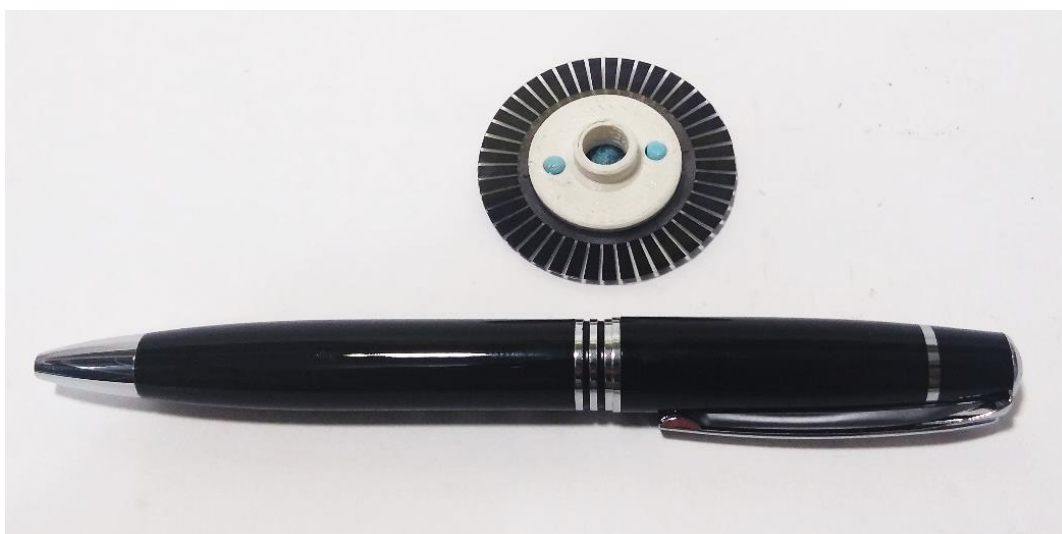
Figura 27 - Disco óptico com 90 divisões por volta utilizado no codificador.
