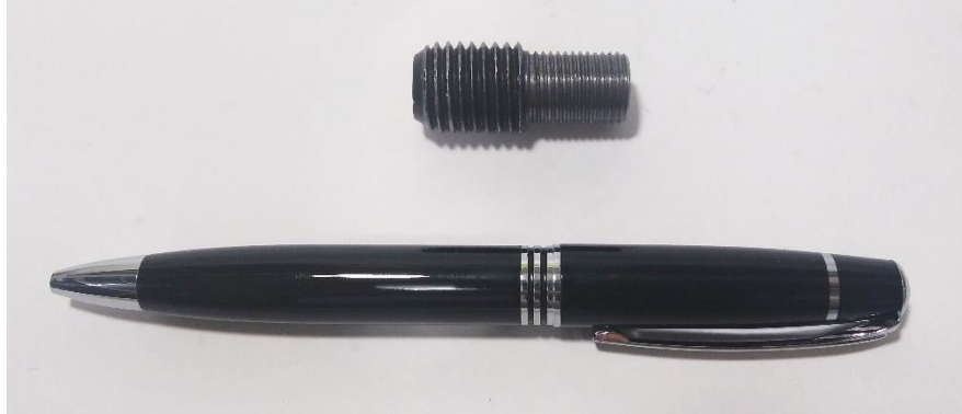
Figura 18 - Adaptador para unir célula de carga com mandril, de um lado uma rosca M16 e do outro uma rosca UNF 1/2".
