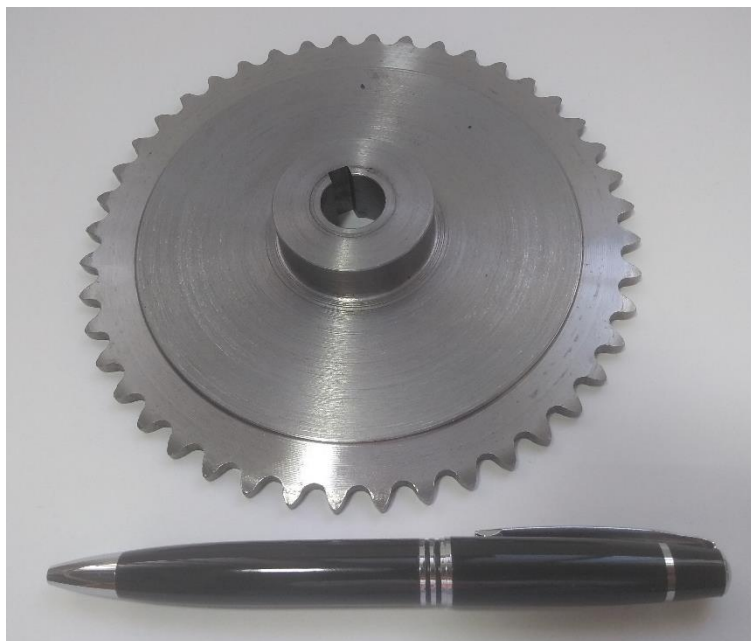
Figura 15 - Coroa para corrente ASA 35-1 de 44 dentes.
