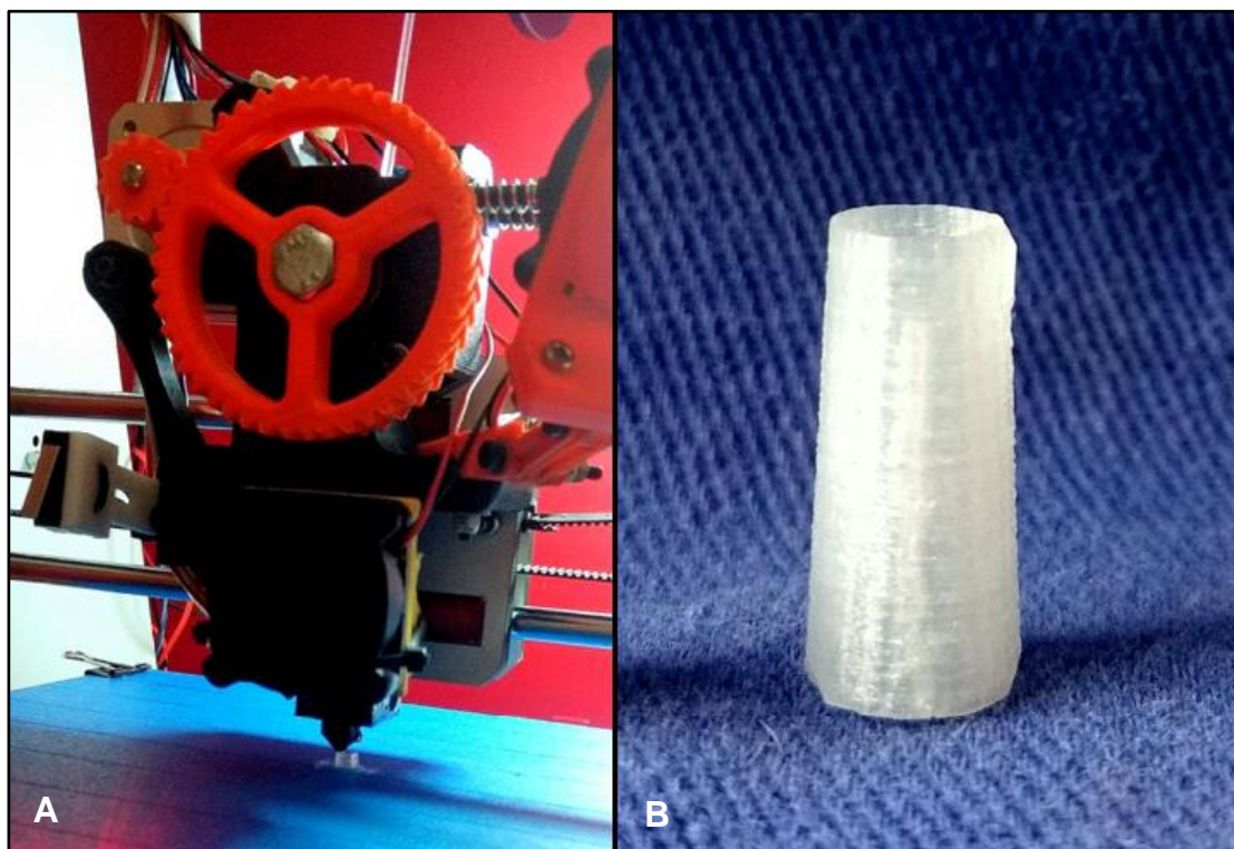
Figura 2 - (A) Prótese no ato de impressão em 3D pelo método de modelagem por fusão e deposição em impressora da marca Prusa modelo I3. (B) Imagem fotográfica das próteses traqueais confeccionada em impressora em três dimensões com nylon associado a elastômero termoplástico. Fonte: Arquivo pessoal.
