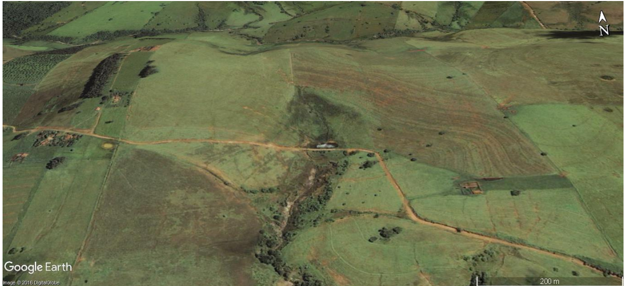
Figura 39: Processo de voçorocamento em vertentes côncavas Fonte: Imagem do Google Earth® de 13/08/2011
