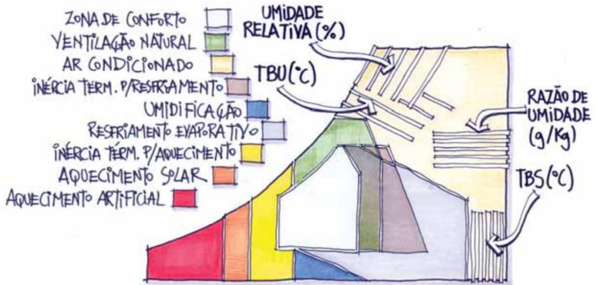
Figura 3 - Carta bioclimática adotada para o Brasil
