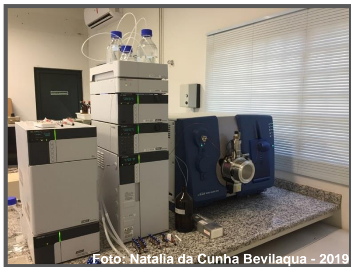
Figura 5 - Cromatógrafo líquido (Prominence UFLC) acoplado ao espectrômetro de massas (Triple Quad 4500, AB Sciex).
