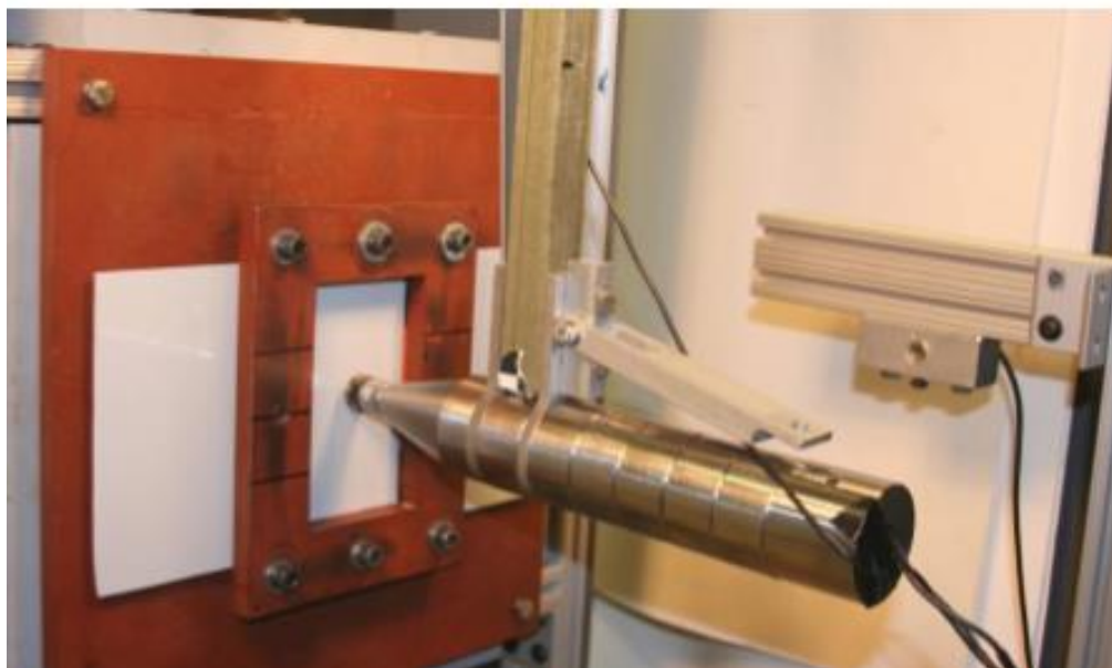
Figura 3.20 – Sistema do pêndulo de impacto.
