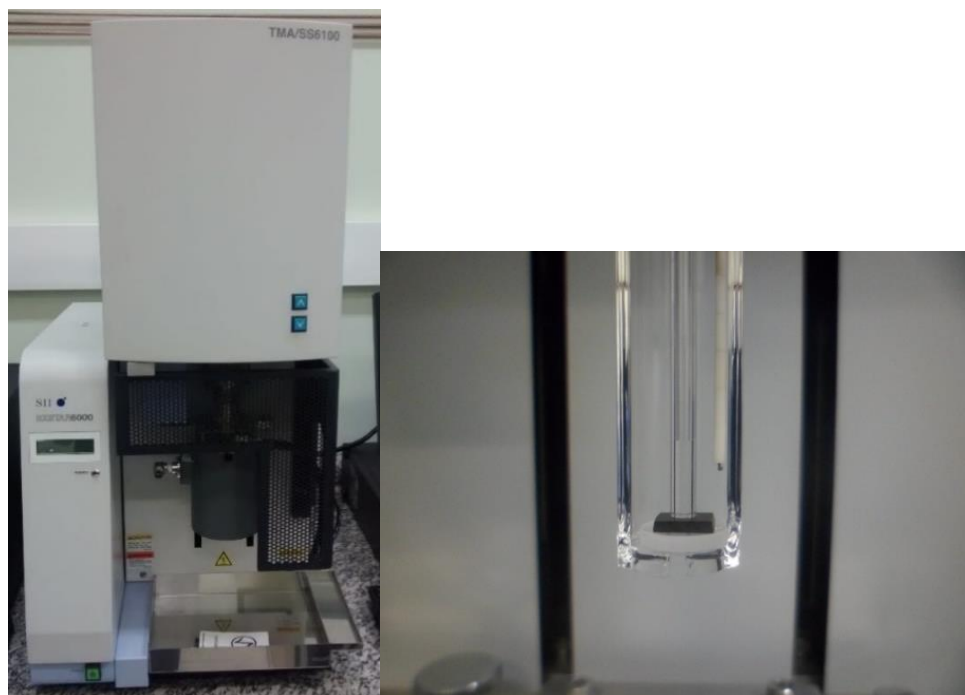
Figura 3.13 – Equipamento de TMA da SII Nanotechnology e o porta-amostra.
