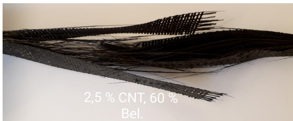
Figura 4.41 – Amostra de RF/FC/2,5% CNT ensaiada com 60% de carga.
