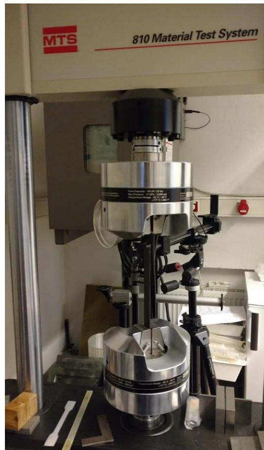
Figura 3.23 – Máquina universal de testes usada para o ensaio de fadiga.
