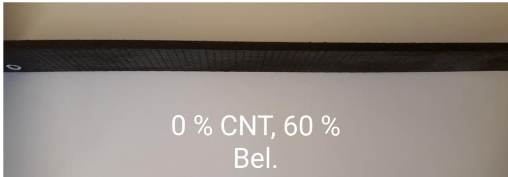
Figura 4.39 – Amostra de RF/FC/0% CNT ensaiada com 60% de carga.
