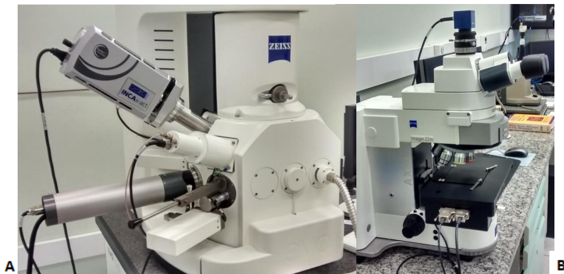
Figura 3.12 – Equipamentos de microscopia: MEV (A) e MO (B).
