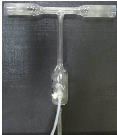
Figura 08: Projeto e imagem da construção do separador gás-líquido integrado com o atomizador de quartzo.
