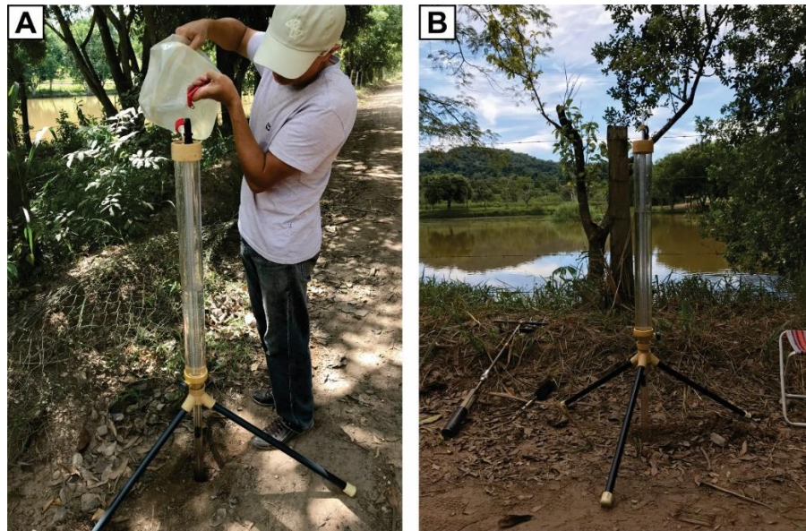
Figura 5.9 – (A) Preenchimento dos reservatórios com água. (B) Permeâmetro pronto para realização do ensaio.
