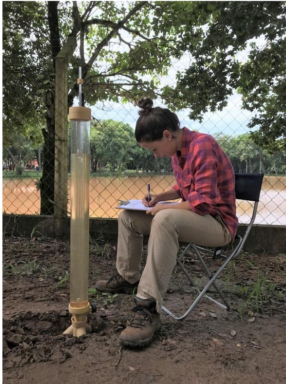
Figura 5.10 – Leitura e anotação das medidas de variação de nível d'água durante o ensaio de permeabilidade de solo.
